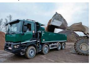
Renault Trucks rüstet sein Zusatzantriebssystem Optitrack auf: In der neuesten Ausbaustufe haben die Franzosen den Hydraulikdruck des Systems eigenen Angaben zufolge von 420 auf 450 bar erhöht. Dadurch erstarkt das Drehmoment um sieben Prozent. Die maximale Kraft bringt der Antrieb dann laut Renault mit der sogenann-
