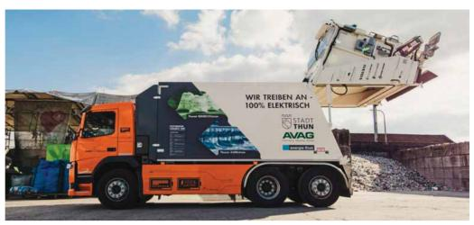
Flüsterleiser Müllschlucker: Der Pressmüllaufbau wird natürlich batterieelektrisch betrieben.
