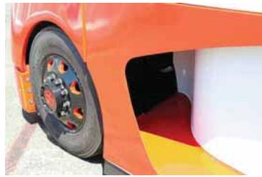
**Hinter dem Vorderrad entweicht die Luft aus dem Motorraum.**
