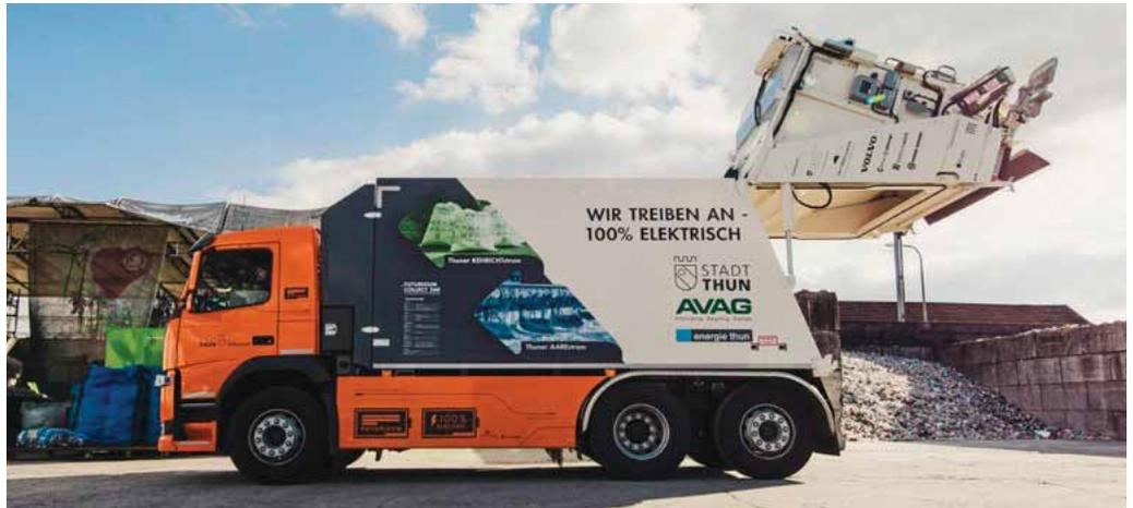
**Flüsterleiser Müllschlucker: Der Pressmüllaufbau wird natürlich batterieelektrisch betrieben.**
