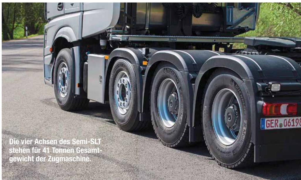
Die vier Achsen des Semi-SLT stehen für 41 Tonnen Gesamtgewicht der Zugmaschine.
