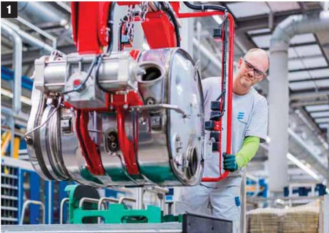
**1** Je nach Version bringen die Abgasboxen 100 bis 170 Kilogramm auf die Waage – Hebehilfen sind da Pflicht.
