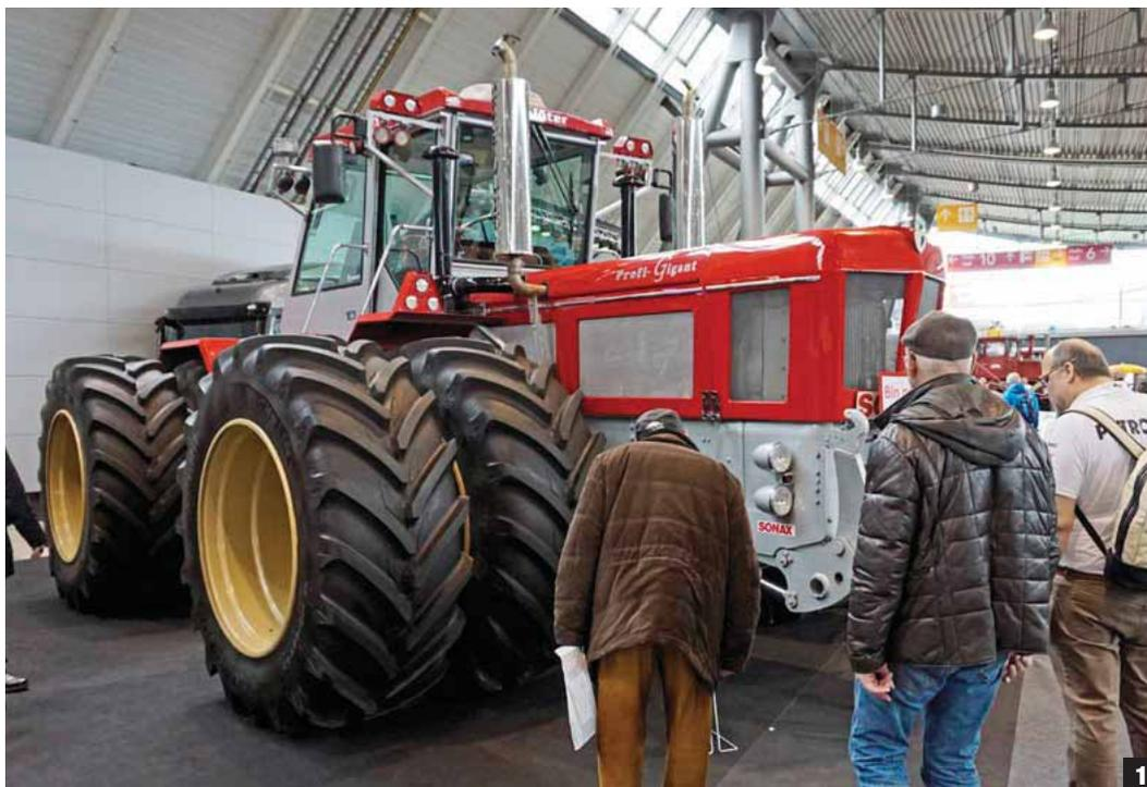
**1** Größter Radschlepper Europas: Durch den Umbau eines Schlüter Profi Trac 3500 entstand 2008 der „Profi Gigant“ mit Doppelbereifung, 20 Tonnen Gewicht und 650 PS.
