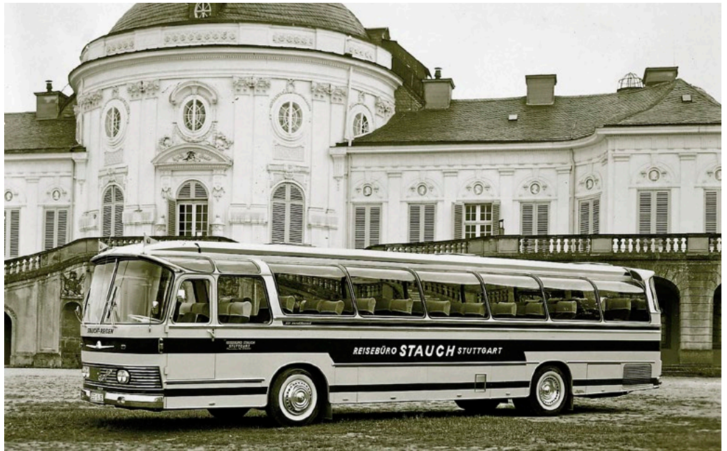
Dank des einfachen Modulbaukastens konnten schnell verschiedene Längen realisiert werden.
