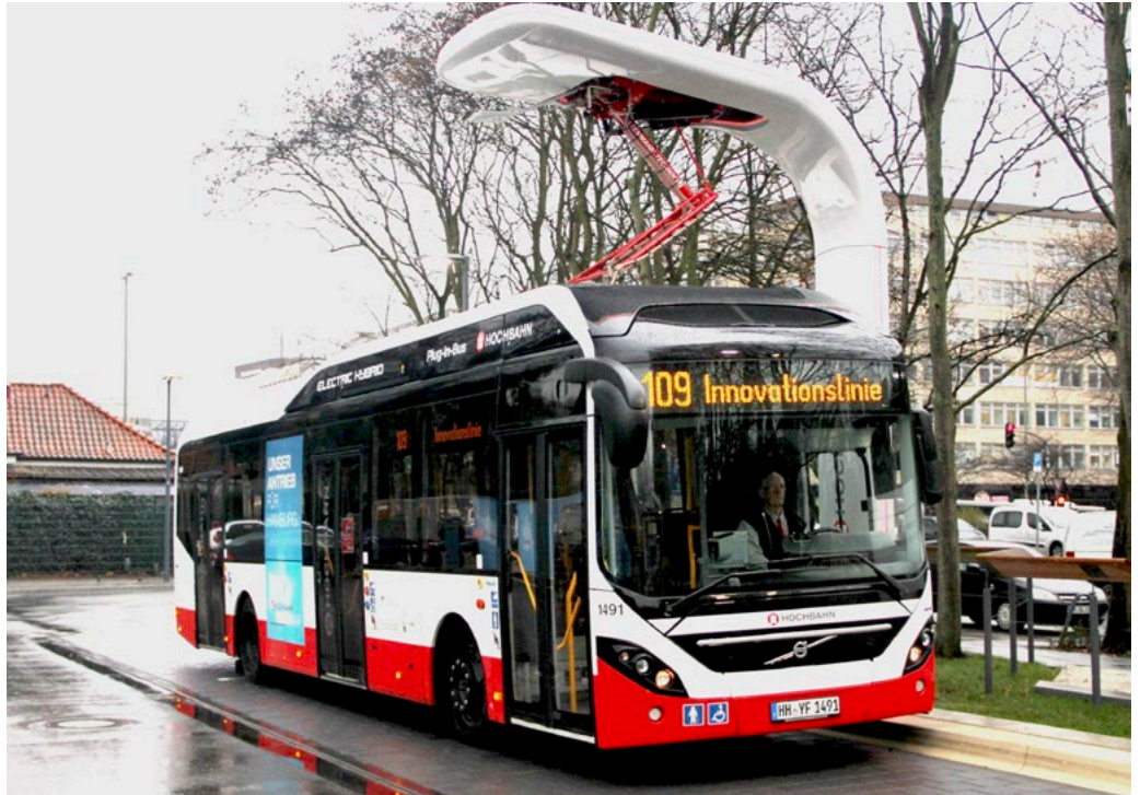
Plug-in-Hybride mit Zwischenladung, wie dieser von Volvo, sind die ideale Brückentechnologie.
