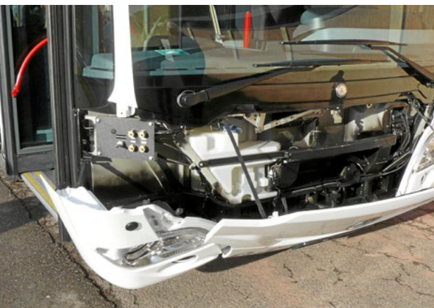
Ohne Werkzeug oder Schlüssel macht sich der Citaro flugs zum Lampenwechsel frei.
