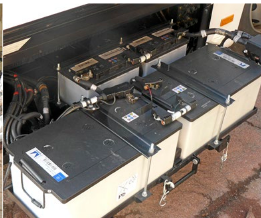
Hinter den Serienakkus lauern zwei weitere Starterbatterien auf frostige Frühstarts.
