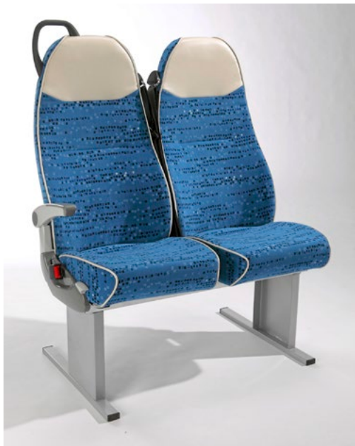
17 Prozent weniger Gewicht: neuer Kiel Lite 3 alias Ligero für Überlandbusse.
