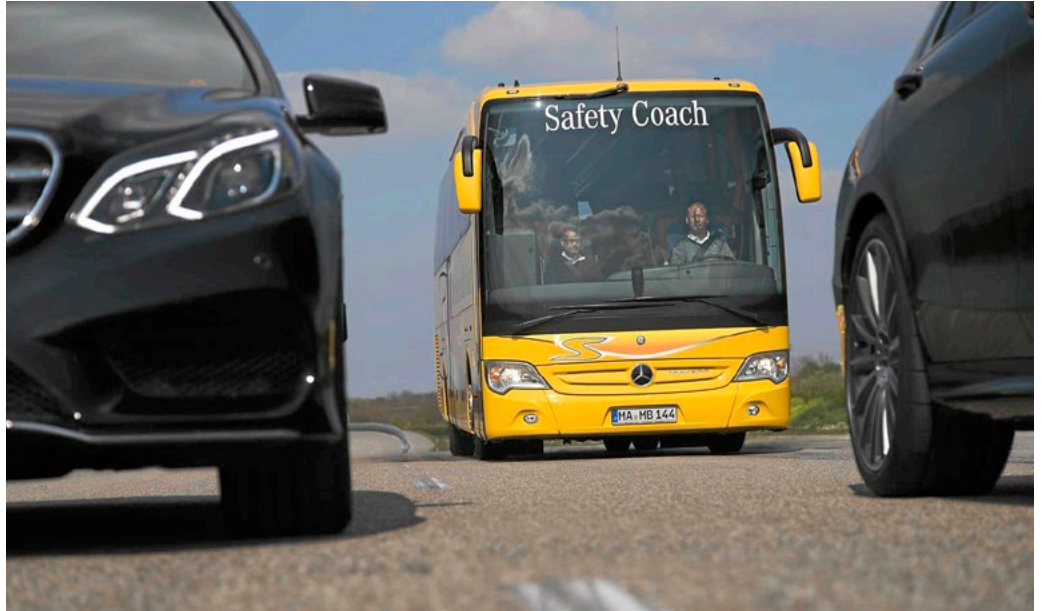
Ein Walzensensor hinter dem Stern schickt seine Radar-Feldwolke bis zu 250 Meter voraus.
