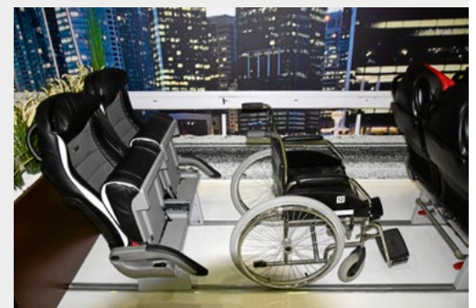
Großer Vorteil: Bei dieser verschiebbaren Lösung können die Sitze im Bus verbleiben.
