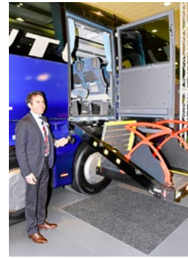
Barrierefreier Zugang wird für Reisebusse immer wichtiger wie hier bei VDL im FHD2.
