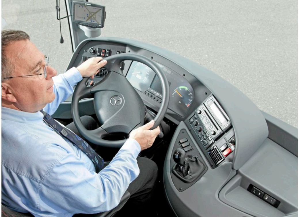
Das Cockpit stammt aus den großen Bussen, Joystick-Bedienung auch für Powershift.
