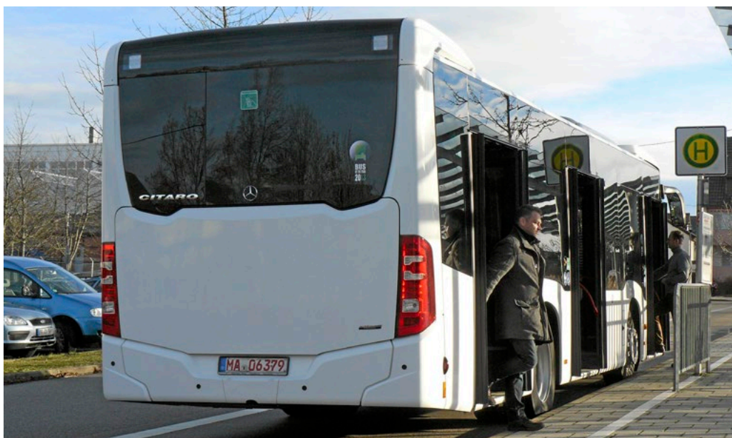
Kurzer Bus mit hohem Heck, drei breite Türen auf Niederflurniveau für flotten Fahrgastwechsel.
