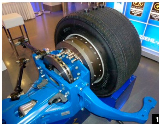
1 Die Motoren sitzen beim ZAWheel in der Radnabe und bedingen Super-Single-Reifen.
