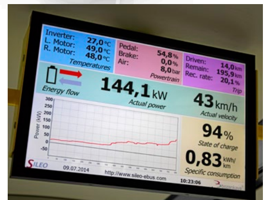
Der Elektrobus Sileo von Bosankaya gibt bereitwillig Auskunft über den Lade-Zustand.
