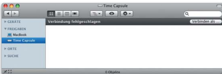
Ist der Gastzugriff auf Time Capsule deaktiviert, gibt es beim ersten Verbindungsversuch eine Fehlermeldung. Man muss sich dann mit dem Passwort anmelden.
