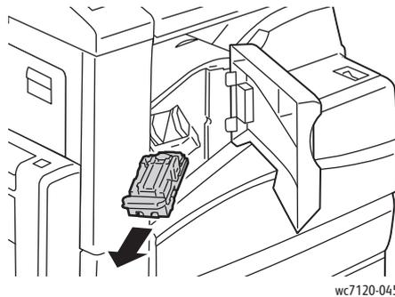
3. Das Innere des Finishers auf lose Heftklammern überprüfen und diese ggf. entfernen.
