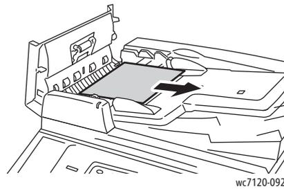
3. Enthält die Meldung auf dem Touchscreen die Anweisung, den Knopf zu drehen, diesen drehen, damit das Papier ausgeworfen wird. Das Papier vorsichtig aus dem Vorlageneinzug ziehen.
