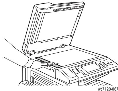
Zur Säuberung der Unterseite der Vorlagenglasabdeckung und des Inneren des Vorlageneinzugs ein fusselfreies Tuch mit Xerox-Reiniger oder Xerox Filmentferner befeuchten.
