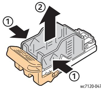
5. Neuen Heftklammerbehälter mit der Vorderseite zuerst in das Magazin einsetzen (1), dann das hintere Ende in das Magazin drücken (2).
