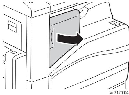
2. Das Heftklammermagazin am orangefarbenen Griff fassen und gerade aus dem Finisher herausziehen.
