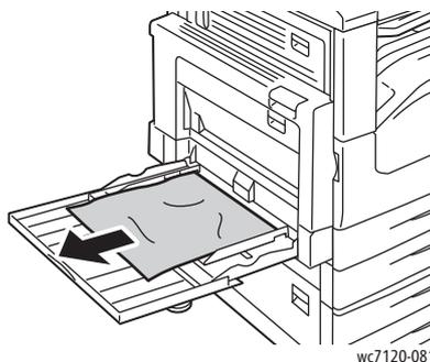
2. Ist das Papier zerrissen, darauf achten, dass sich keine Papierreste mehr im Gerät befinden.
