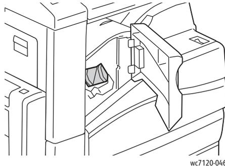
4. Beide Seiten des Heftklammerbehälters (1) zusammendrücken und diesen aus dem Magazin (2) entfernen.
