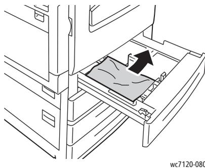
3. Ist das Papier zerrissen, den Behälter ganz entnehmen und sämtliche Papierreste aus dem Gerät entfernen.
