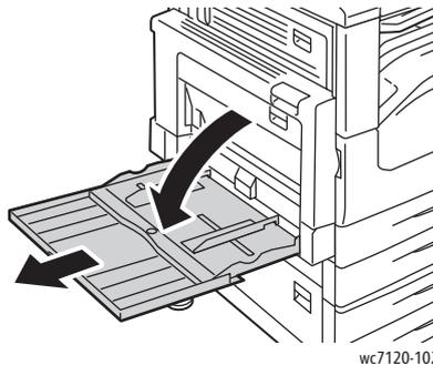
2. Druckmaterial einlegen (mit der Längs- oder Schmalseite voraus). Größere Formate müssen mit der Schmalseite voraus zugeführt werden.
