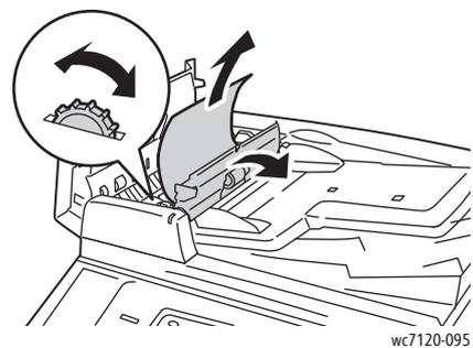
6. Die innere Abdeckung schließen, dann die obere Abdeckung des Vorlageneinzugs schließen und darauf achten, dass sie einrastet. Die Abdeckung muss vorne und hinten vollständig geschlossen sein.
