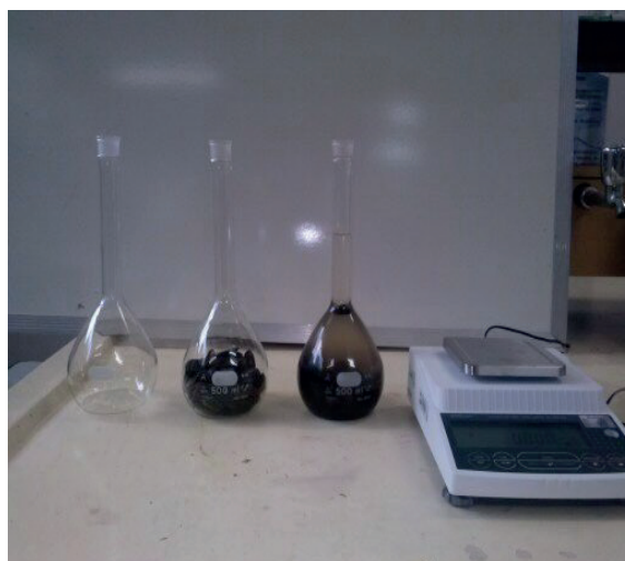
Figura 6. Aparato usado para determinar a massa específica absoluta das sementes de puxuri por picnometria de comparação (Foto: Eduardo Mafra)
