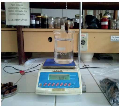
Figura 7. Aparato usado para determinar o volume das sementes pelo Método Hidrostático usando água destilada como líquido mostrando a semente antes da submersão (Foto: Eduardo Mafra)
