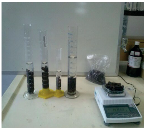
Figura 5. Aparato usado para determinar a densidade das sementes de puxuri pelo método do deslocamento de líquidos (Foto Eduardo Mafra)
