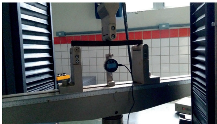
Figura 1. Execução do teste de flexão estática em máquina universal de ensaios mecânicos.
