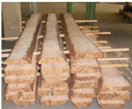
Figura 2. Tábuas retiradas das toras dos clones H e L em secagem ao ar.
