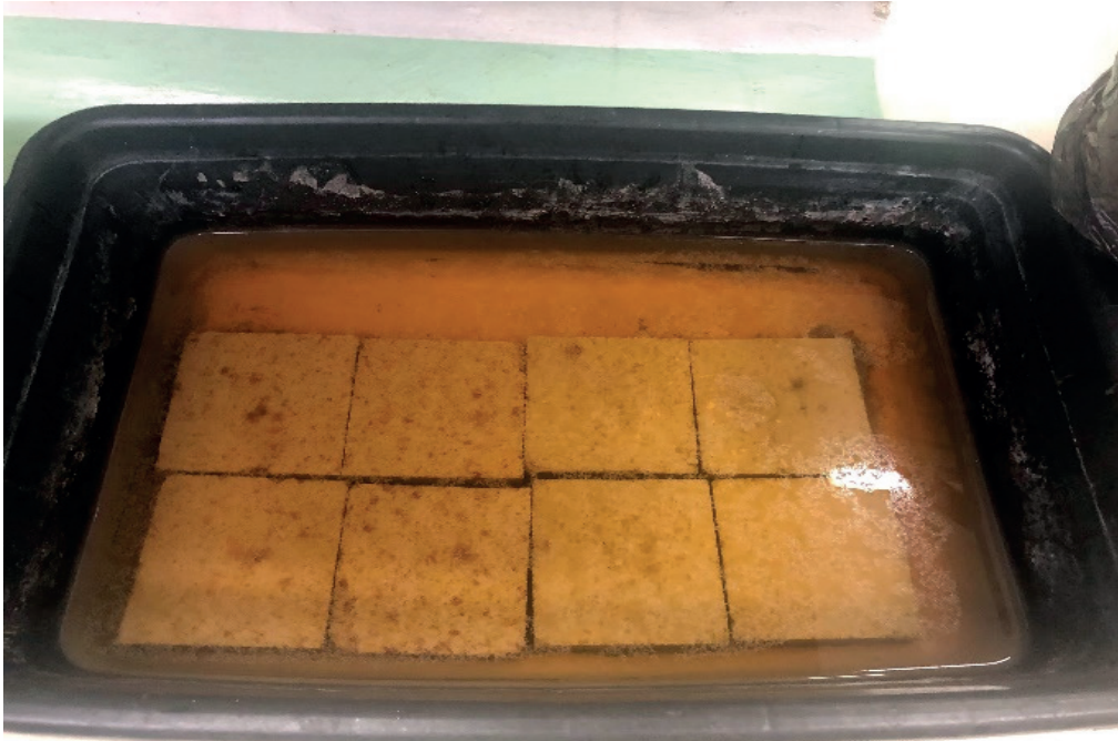
Figura 6. Corpos de prova prismáticos imersos em água.
