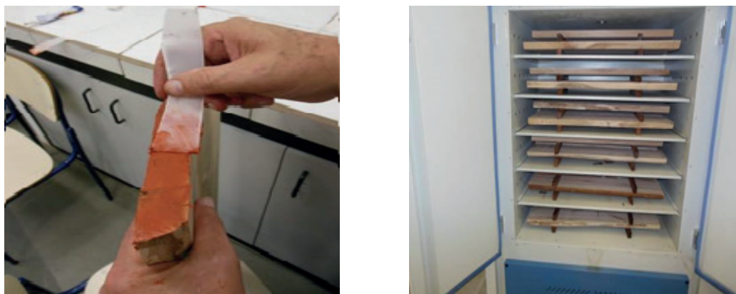
Figura 3. Preparo (A) e acomodação (B) das peças de madeira para a termorretificação.
