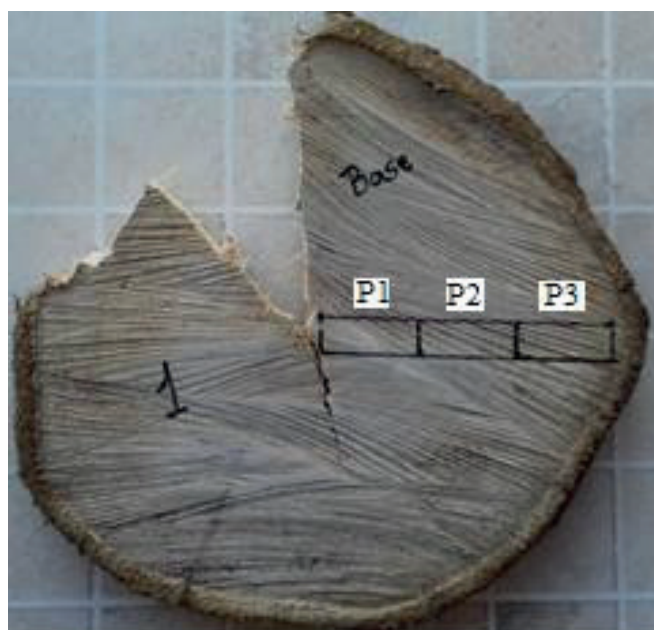
Figura 1. Representação da marcação radial da bagueta com as posições 0 (P1), 50 (P2) e 100% (P3).
