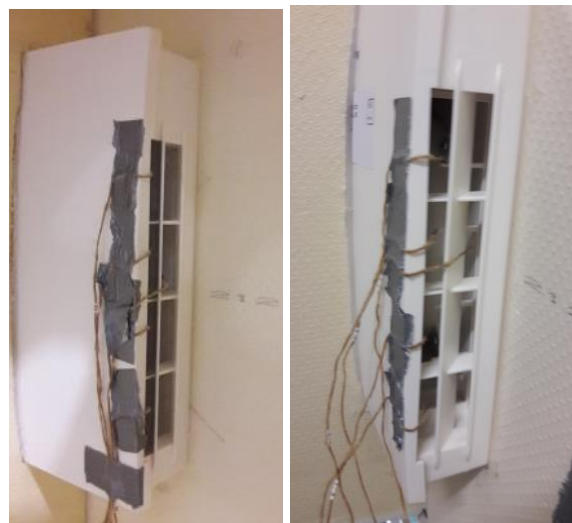
Abbildung 58: Platzierung der Temperaturfühler bei Gerät C innen und außen
