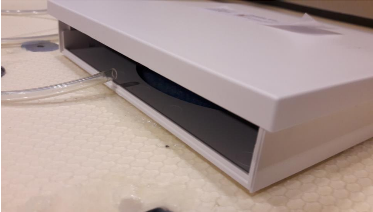
Abbildung 29: Exemplarisch angebrachter Staudruckschlauch
