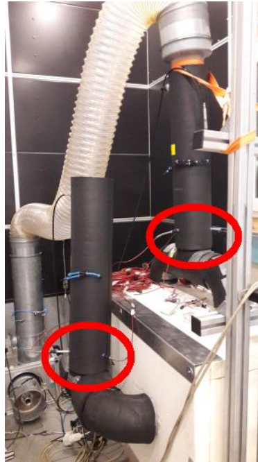
Abbildung 59: Förderung der Spülluft durch die Spülkammer, Temperaturmessstellen am Ein- und Austritt
