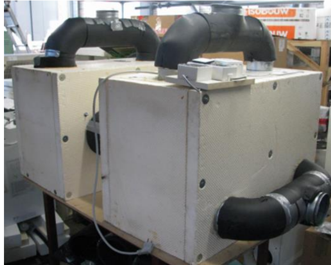
Abbildung 45: Spülluftkammern der Prüfstelle HLK
