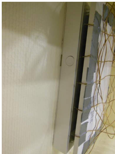
Abbildung 25: Thermoelemente zur Messung der Austrittstemperatur von Gerät 236
