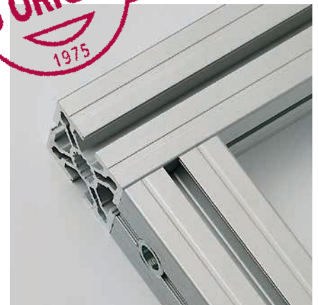
3. Ankerkopf in die Längsnut des Gegenprofils einschieben oder einstecken und abdrehen, die Innensechskantschraube anziehen – fertig.
