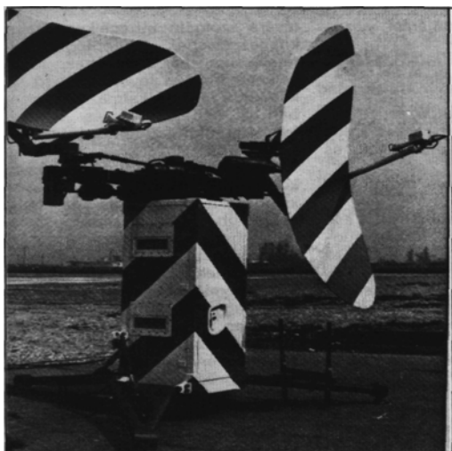
Repülőtéri leszállító rádiolokátor antennarendszere
