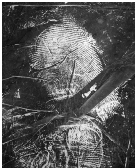
Vlevo obr. 22 – vakuová komora používaná k vakuovému pokovování. 93 | Vpravo obr. 23 – latentní stopa zviditelněná vakuovým pokovením zlatem a zinkem na polyetylenovém pytli. 94
