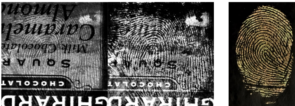
Vlevo obr. 20 – zviditelnění latentního otisku napařováním kyanoakrylátových par ve spektru viditelného světla a po aplikaci fluorescenčního barviva ve světle o vlnové délce 475 nm. 89 | Vpravo obr. 21 – struktura polymerovaného kyanoakrylátu na latentní stopě. 90
