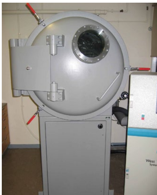
Vlevo obr. 22 – vakuová komora používaná k vakuovému pokovování. 93 | Vpravo obr. 23 – latentní stopa zviditelněná vakuovým pokovením zlatem a zinkem na polyetylenovém pytli. 94
