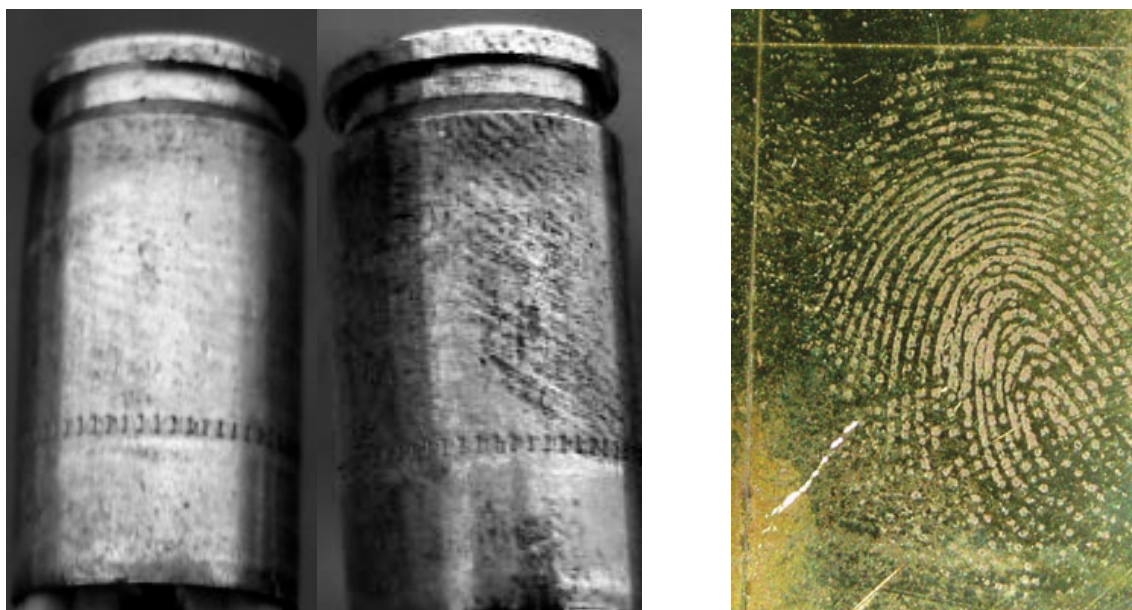
Vlevo obr. 24 – vyleptaný otisk zanechaný na vystřelené nábojnici před a po ošetření elektrostatickým práškem 98 | Vpravo obr. 25 – otisk prstu vyleptaný do mosazné destičky pozorovatelný pouhým okem 99
