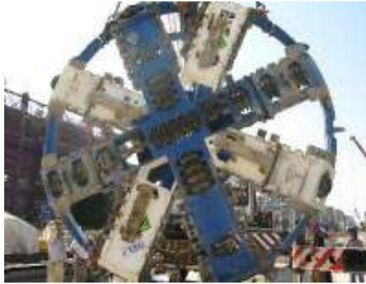
Εικόνα 3 Συναρμολόγηση κοπτικής κεφαλής & τμήμα της πρόσθιας ασπίδας στο εργοστάσιο.
