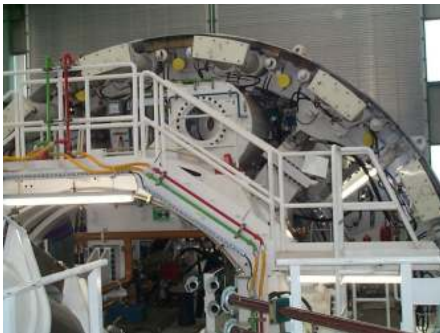
Εικόνα 7 Θάλαμος αποσυμπίεσης και έμβολα προώθησης
