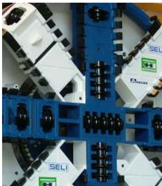
Εικόνα 5 Σιαγόνες σύνθλιψης και κοπτικοί δίσκοι της κοπτικής κεφαλής του EPB
