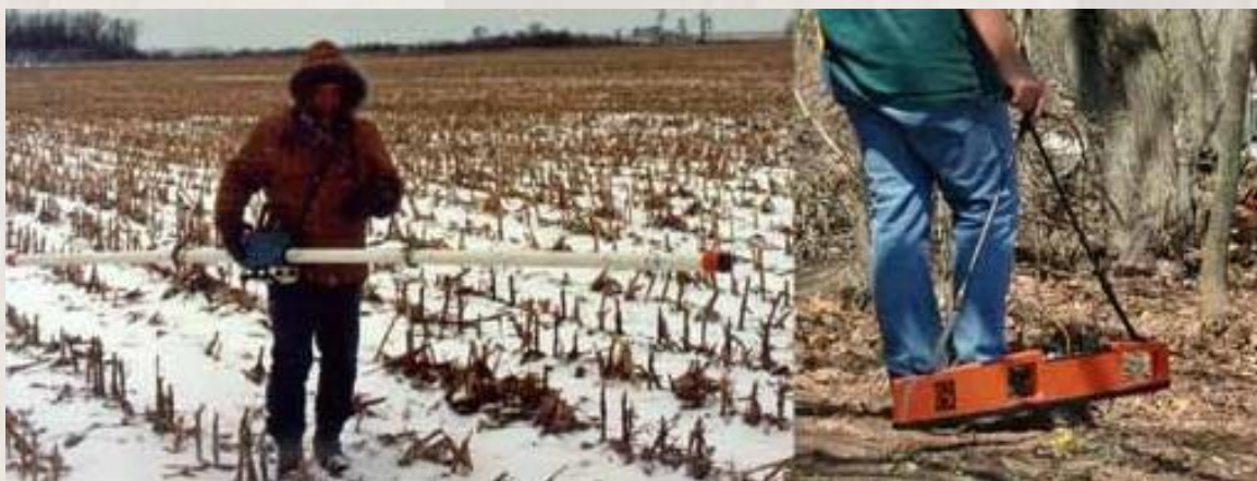
Εικόνα 2.1: Ενδεικτικά μηχανήματα Ηλεκτρομαγνητικής Μεθόδου. Στο αριστερό μέρος είναι το EM-31, και στο δεξί μέρος είναι το EM-38 ( http://geonicsrental.com/ ).
