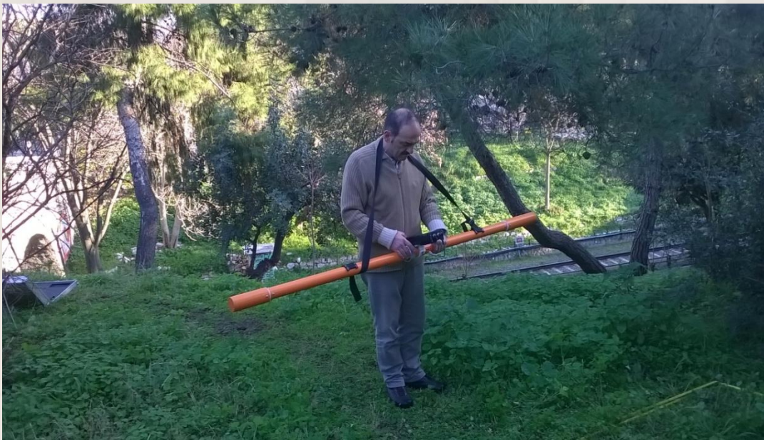
Εικόνα 4.12 : Το όργανο ηλεκτρομαγνητικών μετρήσεων CMD-2.
