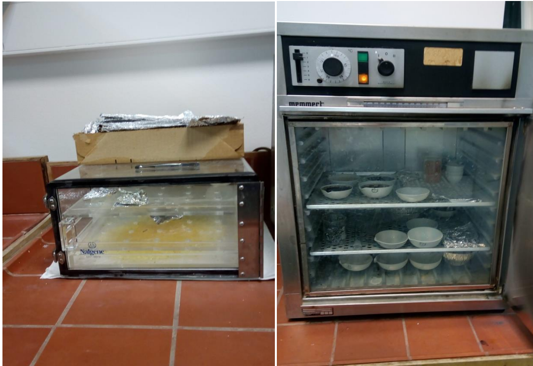
Σχήμα 3.2: Αφυγραντής και κλίβανος που χρησιμοποιήθηκαν για τον προσδιορισμό των TSS και VSS
