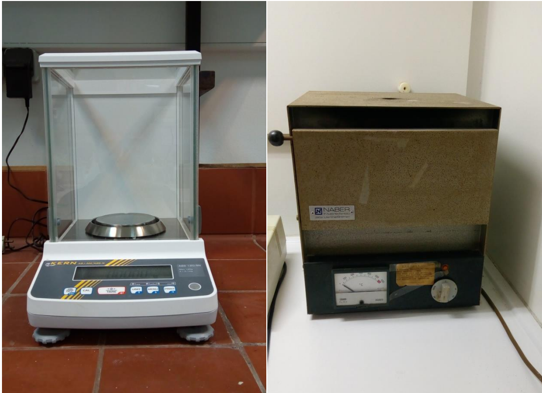
Σχήμα 3.3: Ζυγός και φούρνος 550°C για τον προσδιορισμό των TSS και VSS
