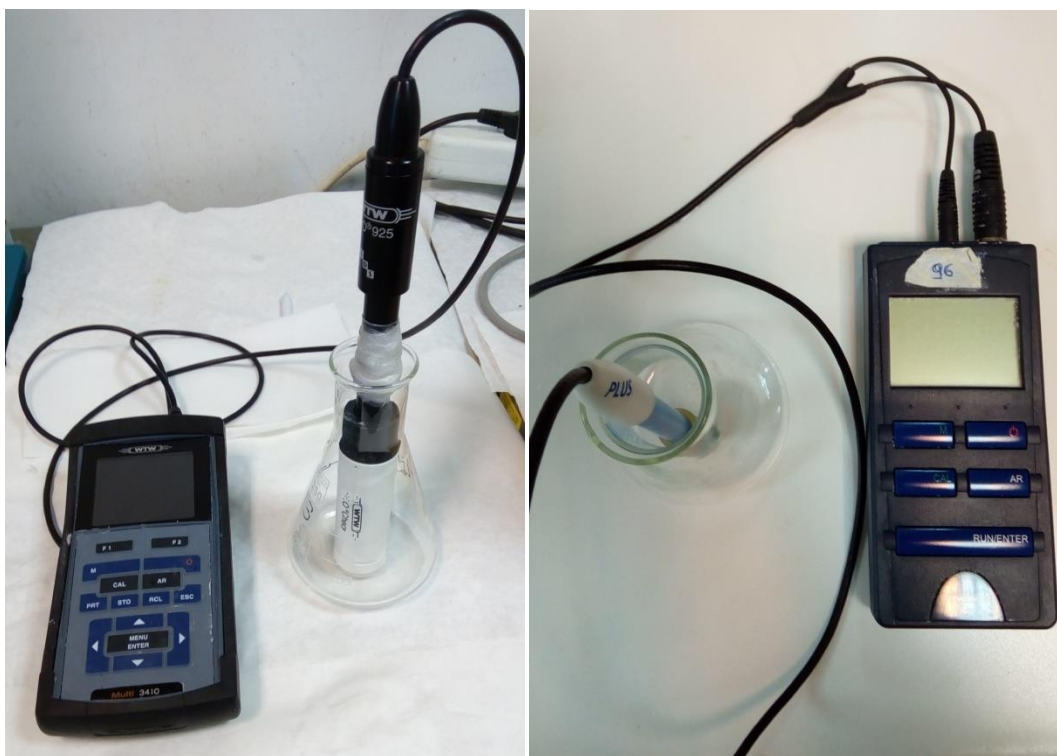
Σχήμα 3.5: Συσκευές προσδιορισμού των DO, pH και θερμοκρασίας
