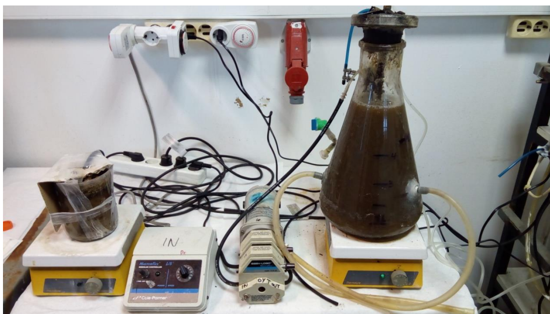
Σχήμα 3.1: Πιλοτικός αντιδραστήρας SBR για την επεξεργασία στραγγιδίων έργων λυόος
