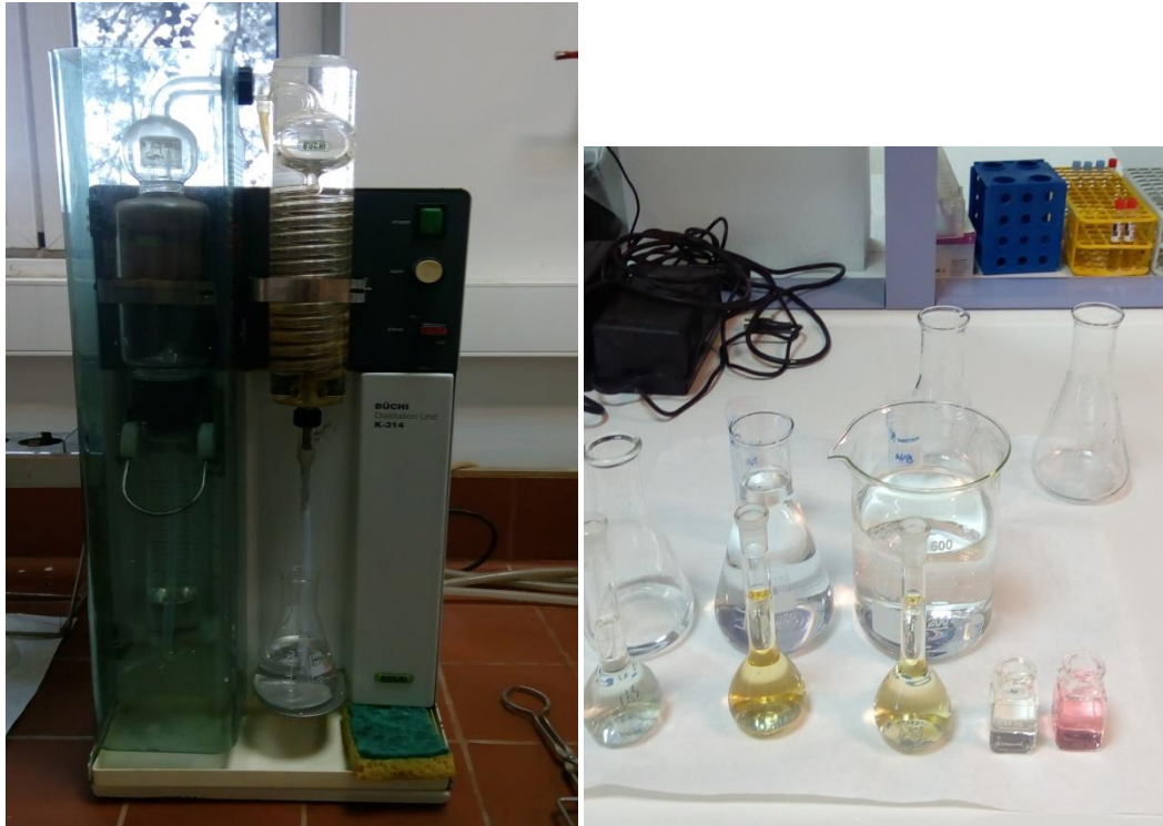
Σχήμα 3.6: Συσκευή απόσταξης BUCHI K-314 και προετοιμασία δειγμάτων για τον προσδιορισμό του αμμωνιακού και νιτρώδους αζώτου
