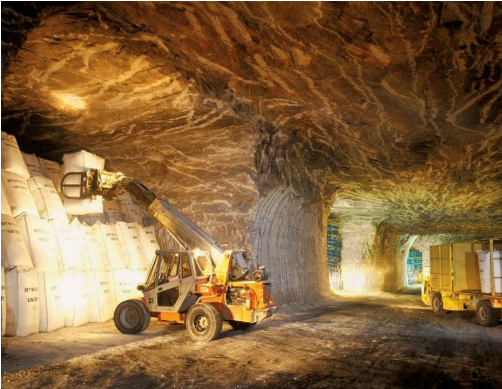
Εικόνα 29 Μέρος των υπόγειων εγκαταστάσεων της Herfa-Neurode που διακρίνονται οι διακριτοί θάλαμοι απόθεσης και οι διαφορετικές συσκευασίες των αποβλήτων.
