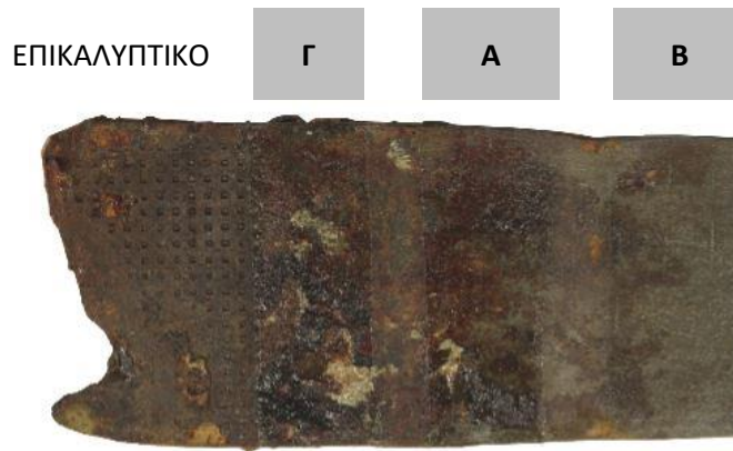
Εικόνα 4.8.2.16: Δείγμα συνδέσμου Σ.245 (όψη Β), ύστερα από 48 ώρες σε θάλαμο αλατονέφωσης.
