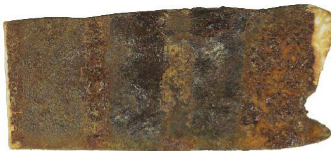
Εικόνα 4.8.2.23: Δείγμα συνδέσμου Σ.245 (όψη Α), ύστερα από 21 μέρες σε θάλαμο με υγρασία.
