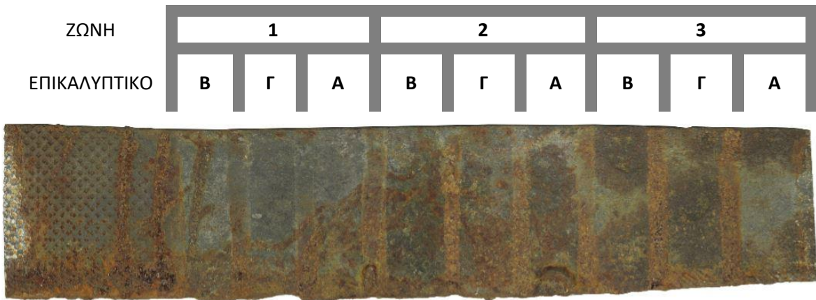
Εικόνα 4.8.2.20: Δείγμα συνδέσμου Σ.214, μετά την αφαίρεση των επικαλυπτικών.
