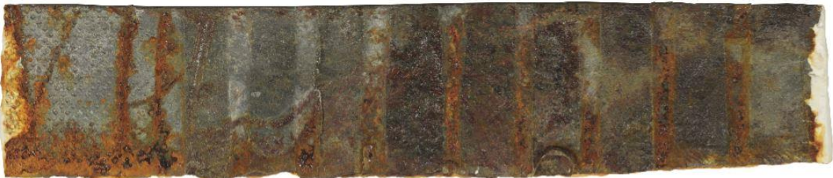
Εικόνα 4.8.2.6: Δείγμα συνδέσμου Σ.214, ύστερα από 48 ώρες σε θάλαμο αλατονέφωσης. Ελάχιστα προϊόντα διάβρωσης αρχίζουν να εμφανίζονται στο επικαλυπτικό Γ της ζώνης 1.
