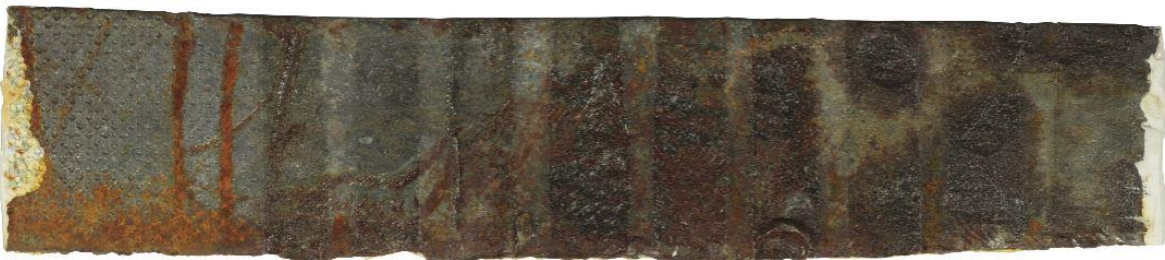
Εικόνα 4.8.2.3: Δείγμα συνδέσμου Σ.214, ύστερα από 5 ώρες σε θάλαμο αλατονέφωσης. Όλα τα επικαλυπτικά έχουν αποτελεσματική αντιδιαβρωτική συμπεριφορά ενώ διάβρωση παρατηρείται μόνο στις μη επικαλυμμένες περιοχές, κυρίως όπου η επιφάνεια είναι ενεργειακά αναβαθμισμένη λόγω μηχανικής καταπόνησης.
