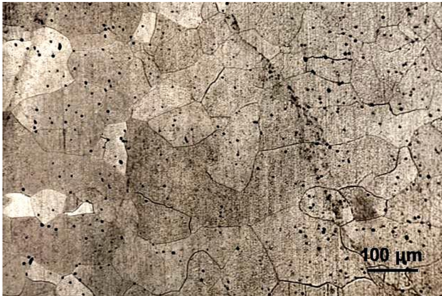
Εικόνα 4.5.2.9: Δείγμα Σ.245 σε οπτικό μικροσκόπιο (100x), κεντρική περιοχή.
