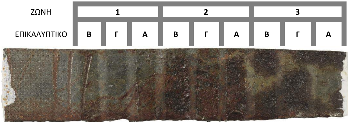
Εικόνα 4.8.1.4: Δείγμα συνδέσμου Σ.214, ύστερα από την εφαρμογή επικαλυπτικών.
