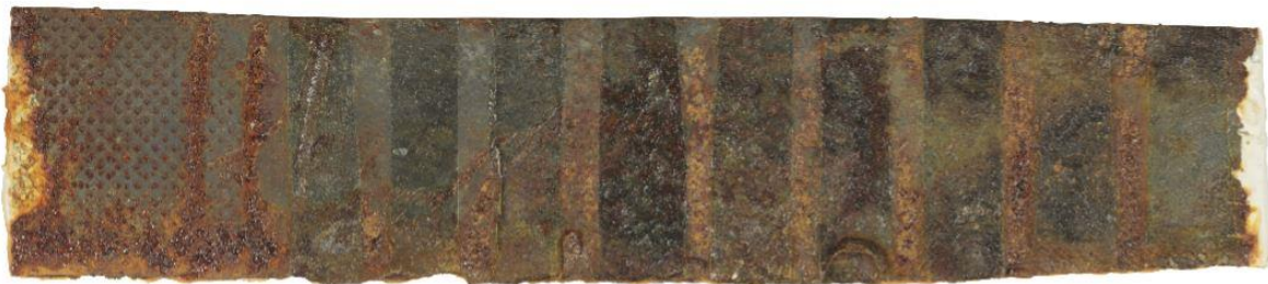
Εικόνα 4.8.2.18: Δείγμα συνδέσμου Σ.214, ύστερα από 14 μέρες σε θάλαμο με υγρασία.
