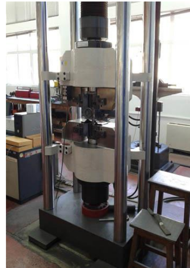
Εικόνα 4.6.2.1: Διάταξη μονοαξονικού εφελκυσμού.
