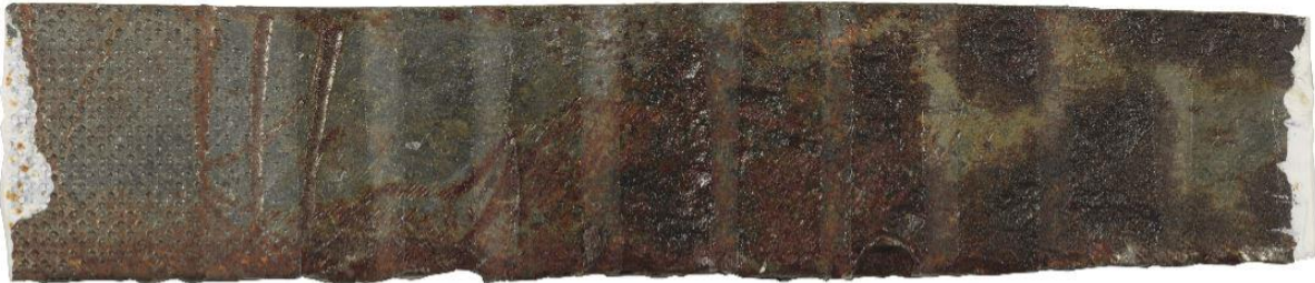
Εικόνα 4.8.2.2: Δείγμα συνδέσμου Σ.214, ύστερα από την εφαρμογή επικαλυπτικών, πριν τοποθετηθεί σε θάλαμο αλατονέφωσης.
