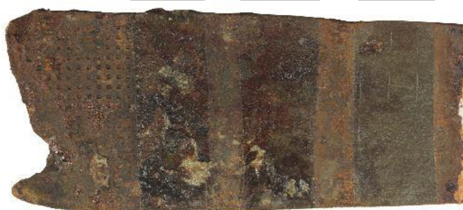
Εικόνα 4.8.2.25: Δείγμα συνδέσμου Σ.245 (όψη Β), ύστερα από 7 μέρες σε θάλαμο με υγρασία.
