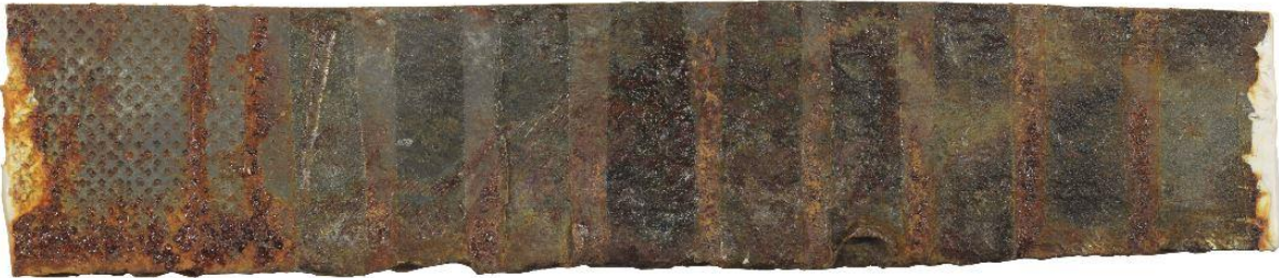
Εικόνα 4.8.2.17: Δείγμα συνδέσμου Σ.214, ύστερα από 7 μέρες σε θάλαμο με υγρασία.
