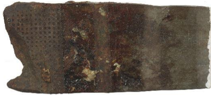
Εικόνα 4.8.2.13: Δείγμα συνδέσμου Σ.245 (όψη Β), ύστερα από την εφαρμογή επικαλυπτικών, πριν τοποθετηθεί στο θάλαμο αλατονέφωσης.
