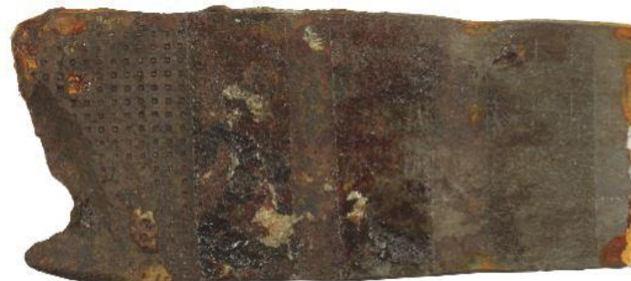
Εικόνα 4.8.2.15: Δείγμα συνδέσμου Σ.245 (όψη Β), ύστερα από 24 ώρες σε θάλαμο αλατονέφωσης.
