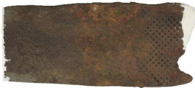
Εικόνα 4.8.1.2: Δείγμα συνδέσμου Σ.245 (όψη Α), ύστερα από τον καθαρισμό με ακετόνη και την εφαρμογή μονωτικού υλικού.
