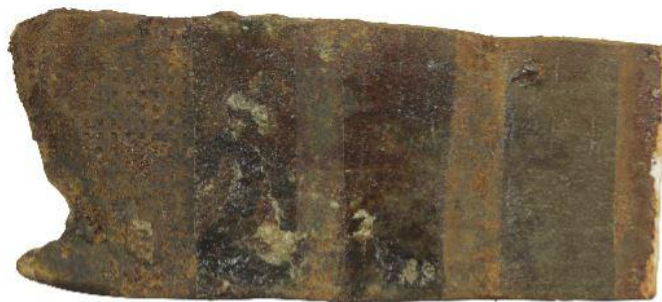
Εικόνα 4.8.2.27: Δείγμα συνδέσμου Σ.245 (όψη Β), ύστερα από 21 μέρες σε θάλαμο με υγρασία.
