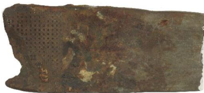
Εικόνα 4.8.1.3: Δείγμα συνδέσμου Σ.245 (όψη Β), ύστερα από τον καθαρισμό με ακετόνη και την εφαρμογή μονωτικού υλικού.
