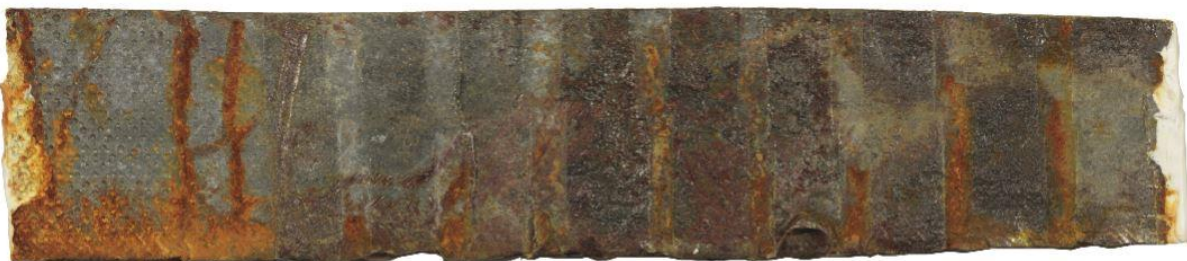
Εικόνα 4.8.2.4: Δείγμα συνδέσμου Σ.214, ύστερα από 24 ώρες σε θάλαμο αλατονέφωσης. Στην ζώνη 1 παρατηρήθηκαν ελάχιστα προϊόντα διάβρωσης μόνο στο επικαλυπτικό Α. Στις ζώνες 2 και 3 παρατηρούνται ελάχιστα προϊόντα διάβρωσης σε όλα τα επικαλυπτικά αλλά το Β παρουσιάζει την καλύτερη αντιδιαβρωτική συμπεριφορά σε όλες τις περιπτώσεις.
