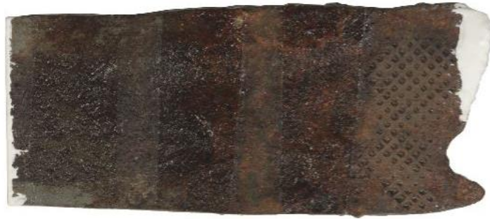
Εικόνα 4.8.2.8: Δείγμα συνδέσμου Σ.245 (όψη Α), ύστερα από την εφαρμογή επικαλυπτικών, πριν τοποθετηθεί στο θάλαμο αλατονέφωσης.
