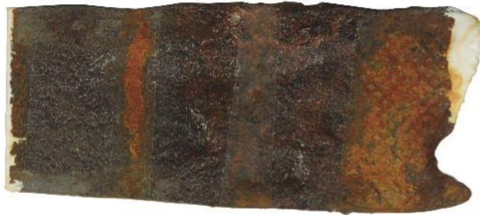
Εικόνα 4.8.2.9: Δείγμα συνδέσμου Σ.245 (όψη Α), ύστερα από 5 ώρες σε θάλαμο αλατονέφωσης. Όλα τα επικαλυπτικά έχουν αποτελεσματική αντιδιαβρωτική συμπεριφορά ενώ διάβρωση παρατηρείται μόνο στις μη επικαλυμμένες περιοχές, κυρίως όπου η επιφάνεια είναι ενεργειακά αναβαθμισμένη λόγω μηχανικής καταπόνησης.
