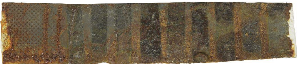
Εικόνα 4.8.2.19: Δείγμα συνδέσμου Σ.214, ύστερα από 21 μέρες σε θάλαμο με υγρασία.
