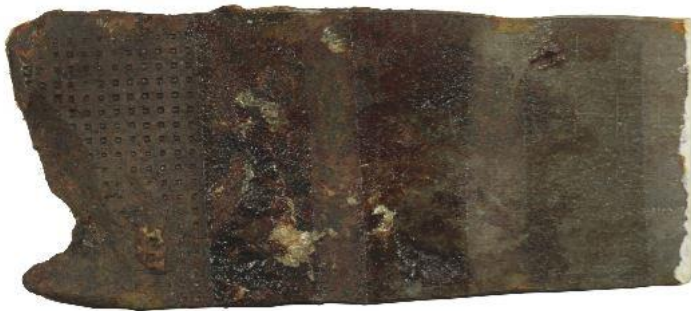
Εικόνα 4.8.2.14: Δείγμα συνδέσμου Σ.245 (όψη Β), ύστερα από 5 ώρες σε θάλαμο αλατονέφωσης.
