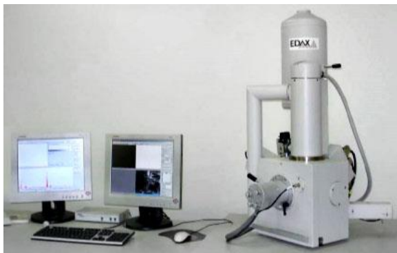
Εικόνα 3.5.3.1: S.E.M. FEI – QUANTA 200 Με σύστημα EDAX (σχολή Χημικών Μηχ. Ε.Μ.Π.).
