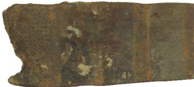
Εικόνα 4.8.2.28: Δείγμα συνδέσμου Σ.245 (όψη Β), μετά την αφαίρεση των επικαλυπτικών.
