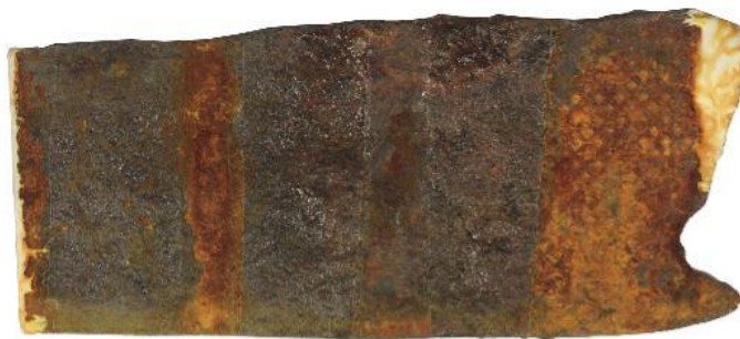
Εικόνα 4.8.2.10: Δείγμα συνδέσμου Σ.245 (όψη Α), ύστερα από 24 ώρες σε θάλαμο αλατονέφωσης. Παρατηρούνται προϊόντα διάβρωσης σε όλα τα επικαλυπτικά στο κάτω μέρος αλλά στο επικαλυπτικό Γ είναι εντονότερα και καλύπτου όλη την επιφάνειά του.
