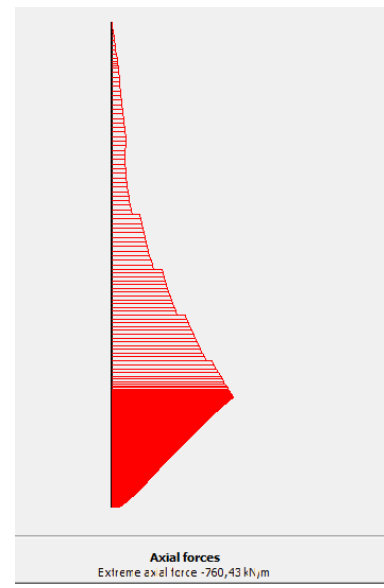
Εικόνα 85: Αξονικές δυνάμεις των πασσάλων για προσωρινή υποστήριξη με επτά σειρές αγκυρίων αντίστοιχα
