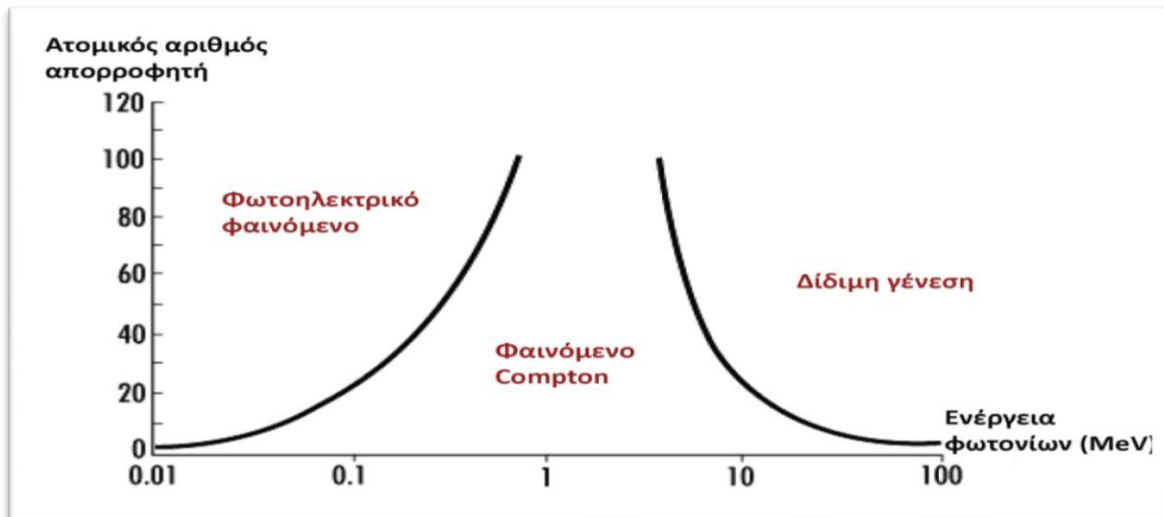
Εικόνα 2.3 Οι ενεργειακές περιοχές όπου κυριαρχεί το κάθε φαινόμενο και η συσχέτιση με τον ατομικό αριθμό του απορροφητή.
