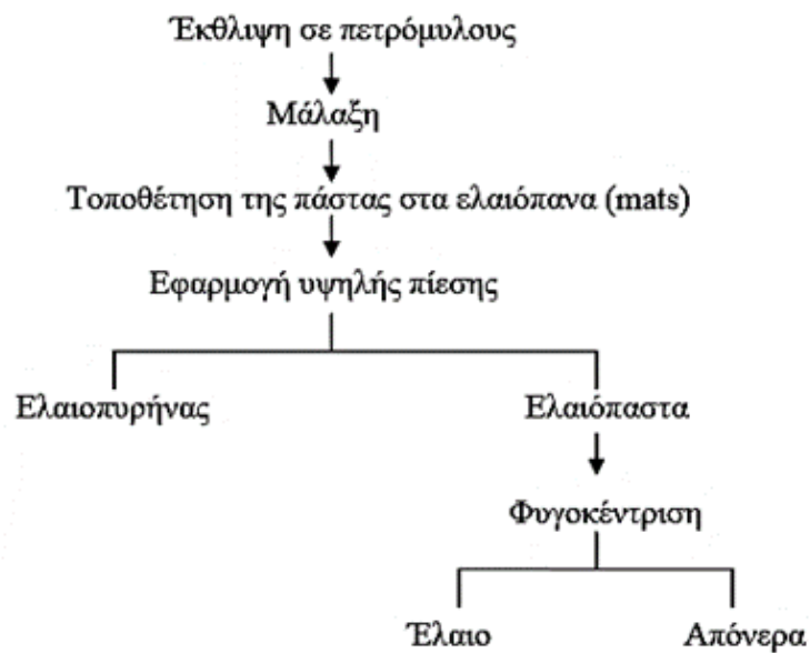
Σχήμα 3.1: Διαγραμματική απεικόνιση παραγωγής ελαιολάδου με τη παραδοσιακή μέθοδο των υδραυλικών πιεστηρίων [27].
