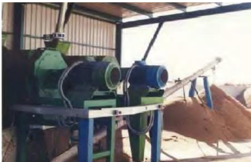
Εικόνα 4.6: Διάταξη που χρησιμοποιείται για την απομάκρυνση των σπασμένων κουκουτσιών στο Αλμπαθέτε (Albacete) της Ισπανίας [25].
