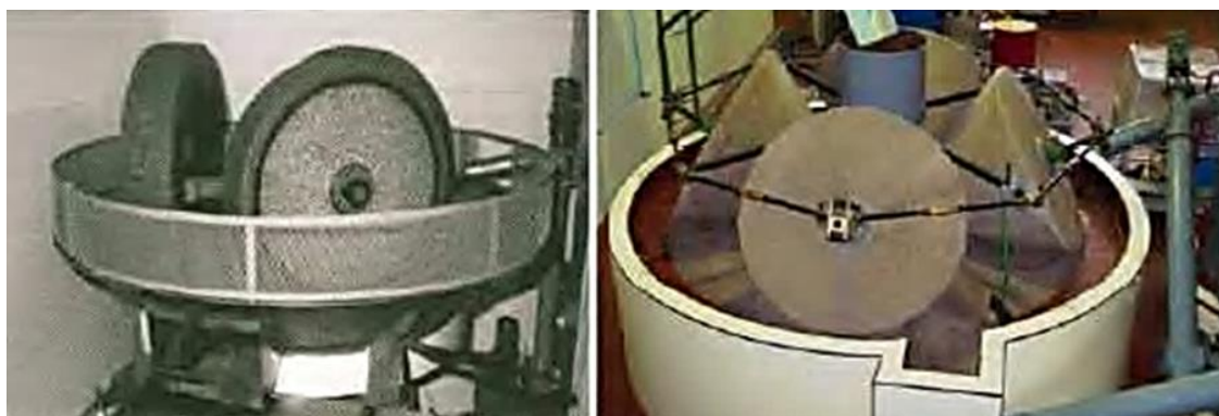
Εικόνα 2.4: Κυλινδρικές μυλόπετρες και μυλόπετρες κωνικού σχήματος [25].
