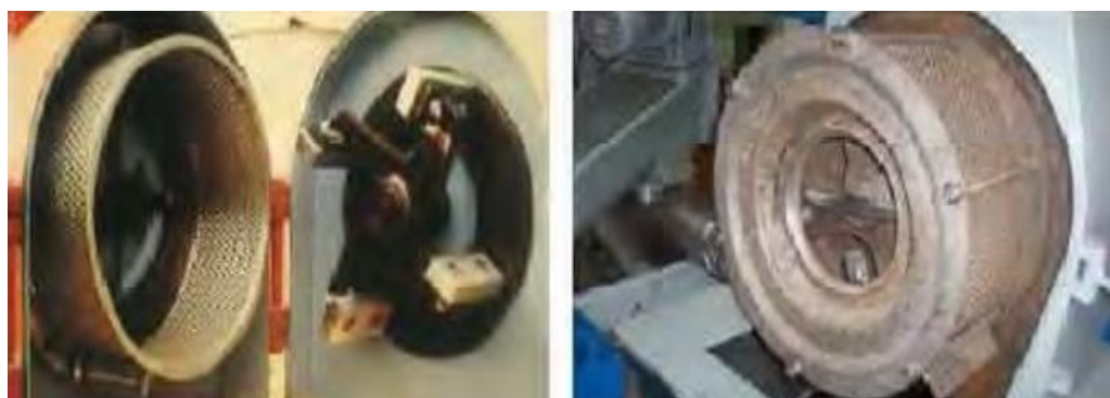
Εικόνα 2.5: Διατάξεις που χρησιμοποιούνται για την σύνθλιψη του ελαιοκάρπου στα σύγχρονα ελαιοτριβεία [25].
