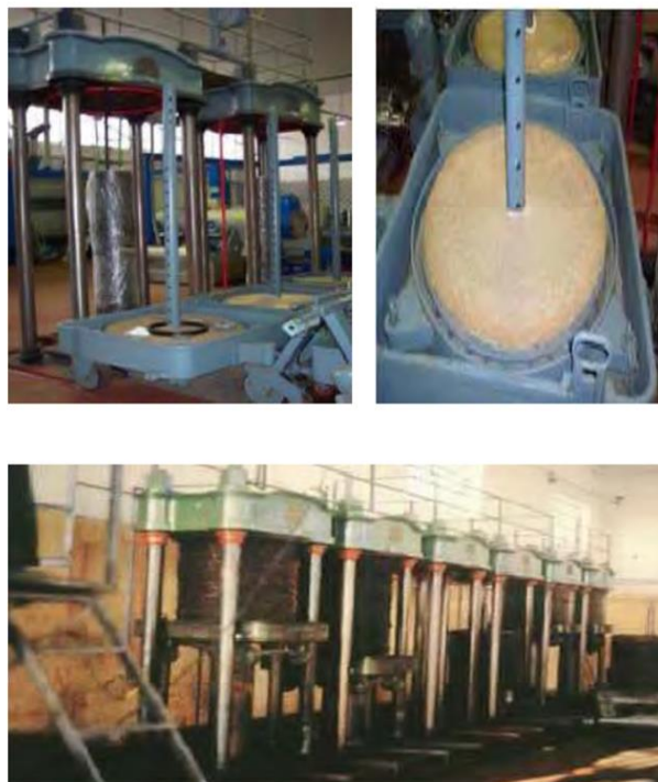
Εικόνα 3.1 : Ο εσωτερικός χώρος παραδοσιακού ελαιοτριβείου. Διακρίνονται οι διατάξεις της πρέσας (κάτω και πάνω αριστερά) και τα ειδικά καροτσάκια (πάνω δεξιά) στα οποία, τοποθετείται η ελαιοζύμη [25].
