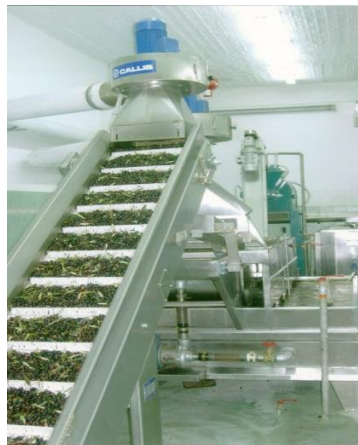
Εικόνα 2.2: Χοάνη παραλαβής και ταινία μεταφοράς του ελαιοκαρπού [25].
