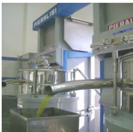
Εικόνα 2.8: Διακρίνεται σύστημα κατακόρυφων φυγοκεντρικών διαχωριστήρων και το παραγόμενο ελαιόλαδο στην έξοδο αυτών [25].
