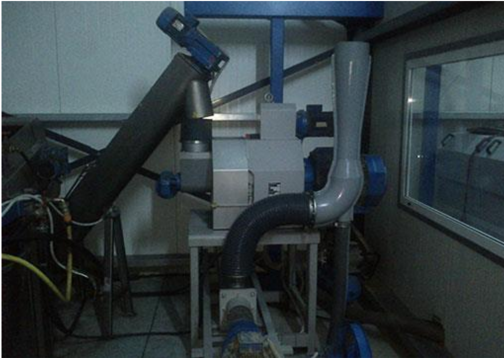
Εικόνα 2.6: Οι πλυμένες ελιές μεταφέρονται με ατέρμονα κοχλία στο θρυπτήριο, που περιέχει ένα μηχανικό σπαστήρα [25].
