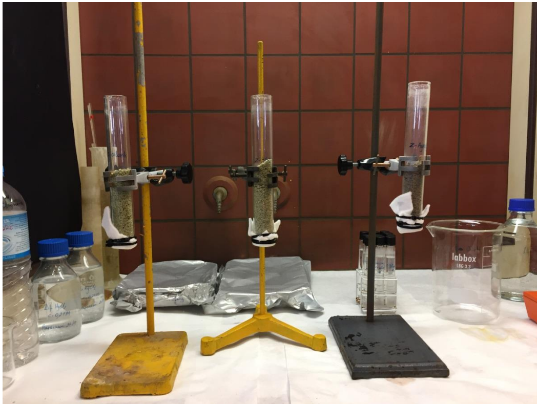
Εικόνα XVI: Πειραματική διάταξη για τη δοκιμή των ορυκτών ως προς την ικανότητα προσρόφησης του Hg από το διερχόμενο διάλυμα HgCl 2 30ppm. Από τα αριστερά προς τα δεξιά η σειρά των ορυκτών είναι η ακόλουθη: φυσικός ζεόλιθος (raw), θερμικά τροποποιημένος ζεόλιθος και ζεόλιθος τροποποιημένος με AgNO 3 .
