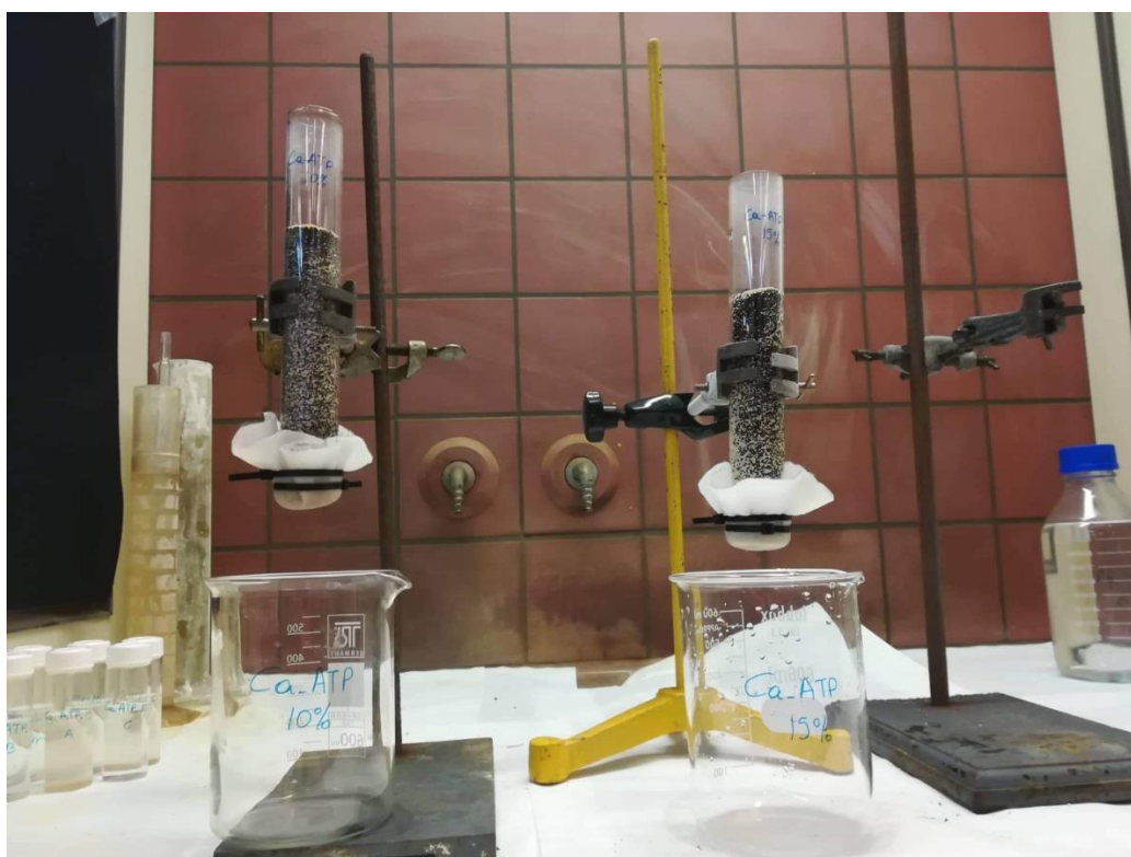
Εικόνα XXI: Πειραματική διάταξη για τη δοκιμή του σύνθετου υλικού (ορυκτού με ρητίνη) ως προς την ικανότητα προσρόφησης του Hg από το διερχόμενο διάλυμα HgCl 2 30ppm.
