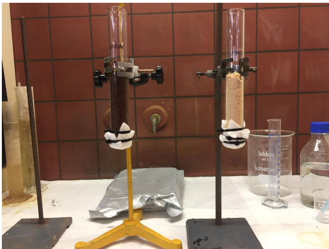
Εικόνα XX: Πειραματική διάταξη για τη δοκιμή των εμπορικά διαθέσιμων ρητινών ως προς την ικανότητα προσρόφησης του Hg από το διερχόμενο διάλυμα HgCl 2 30ppm.
