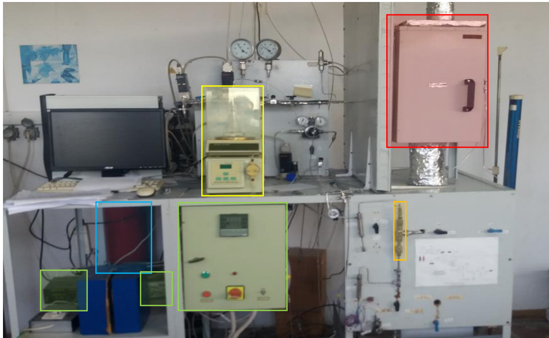
Σχήμα 25: Η μονάδα υδρογονοεπεξεργασίας μίνι- κλίμακας. Διακρίνεται το μονωμένο πλαίσιο μέσα στο οποίο βρίσκεται ο αντιδραστήρας ( κόκκινο χρώμα ), η υγρή τροφοδοσία του κ- δεκαεξανίου πάνω σε ζυγό ( κίτρινο χρώμα ), η μπουκάλα τροφοδοσίας αέριου υδρογόνου ( μπλε χρώμα ), οι ελεγκτές ( πράσινο χρώμα ) και ο διαχωριστής στην έξοδο του αντιδραστήρα ( πορτοκαλί χρώμα ).
