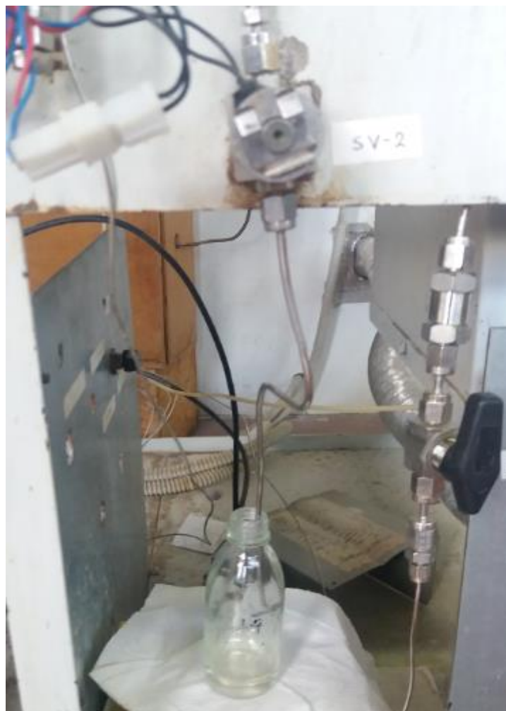
Σχήμα 29: Παραλαβή του Υγρού Δείγματος σε Δοχείο και η θέση της ηλεκτροβάννας SV-2
