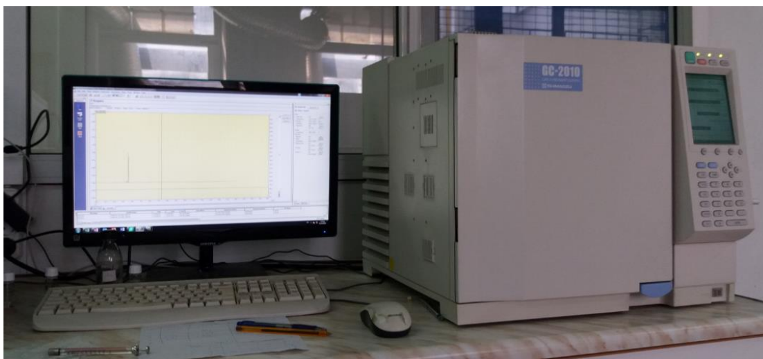
Σχήμα 30: Ο Αέριος Χρωματογράφος GC-2010 της Shimadzu σε επικοινωνία με κατάλληλο λογισμικό Η/Υ.
