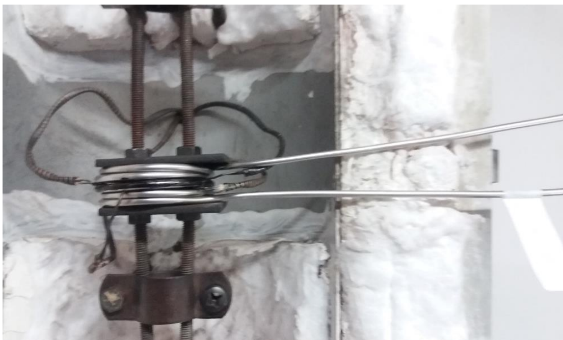
Σχήμα 28: Ο αντιδραστήρας, η θέση της καταλυτικής κλίνης σε αυτόν και τα τέσσερα θερμοστοιχεία στο εσωτερικό του φούρνου
