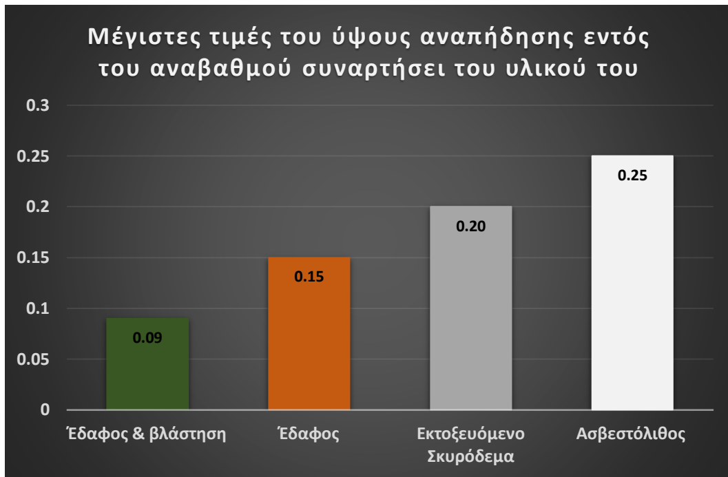
Σχήμα 4.122: Μέγιστες τιμές του ύψους αναπήδησης εντός του αναβαθμού συναρτήσει του υλικού του
