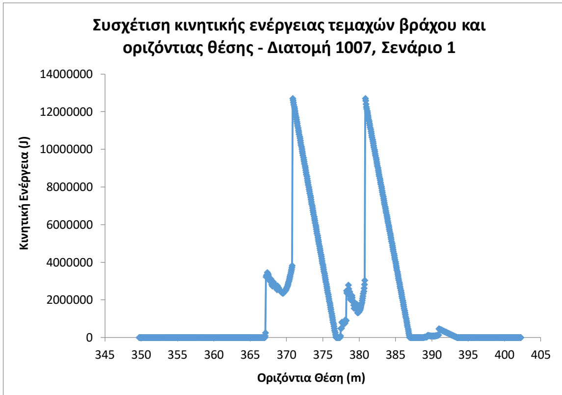
Σχήμα 4.20: Συσχέτιση κινητικής ενέργειας τεμαχών βράχου και οριζόντιας θέσης - Διατομή 1007, σενάριο 1
