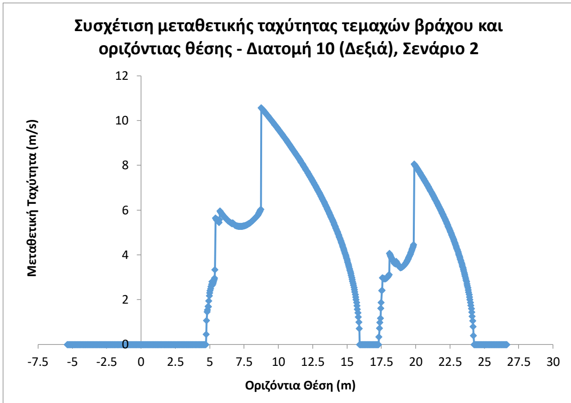
Σχήμα 4.87: Συσχέτιση μεταθετικής ταχύτητας τεμαχών βράχου και οριζόντιας θέσης - Διατομή 10 (δεξιά), σενάριο 2
