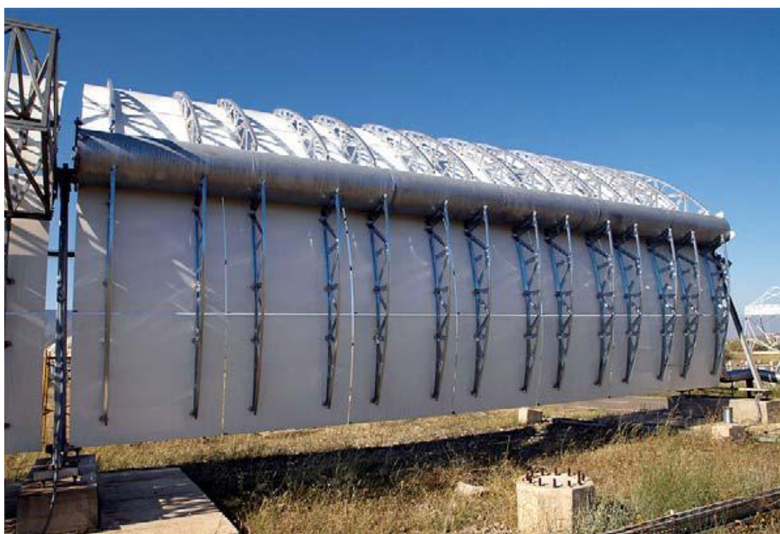
Σχήμα 3.5.9: Οπίσθια όψη συλλέκτη SENERTROUGH-1 (Πηγή: A. F. Garcia et al. “Parabolic-trough solar collectors and their applications”, 2010)
