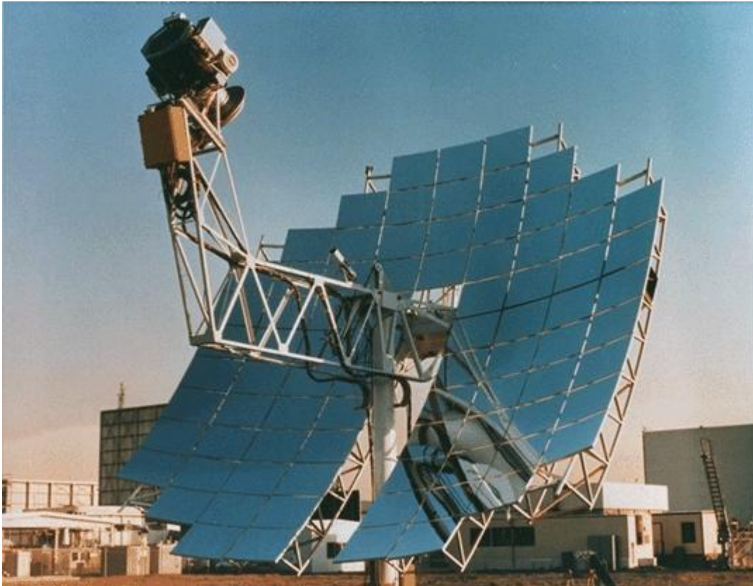
Σχήμα 3.5.21: Δίσκος πολλαπλών κατόπτρων της McDonnell Douglas στην Καλιφόρνια των ΗΠΑ (Πηγή: http://www.stirlingengines.org.uk )
