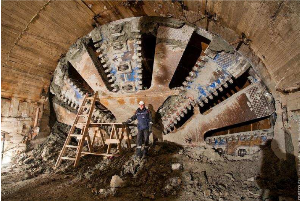
Εικόνα 3.9.5 Το TBM που χρησιμοποιήθηκε για την διάνοιξη της Γραμμής 1 του Μετρό της Αγ. Πετρούπολης
