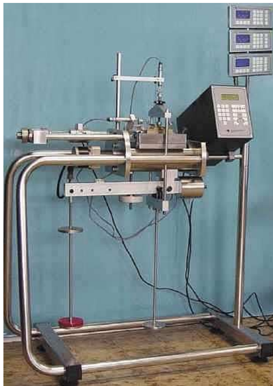
3.8.8.1 Συσκευή απευθείας διάτμησης
