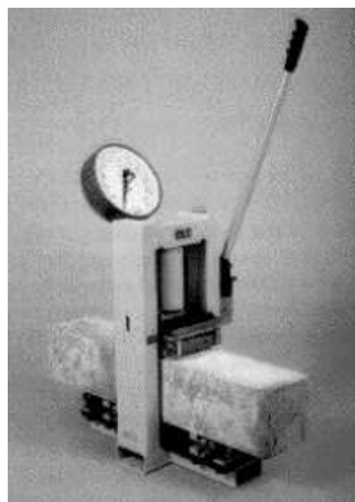
Εικόνα 3.8.14.3 Πειραματική διάταξη δοκιμής πετρώματος σε κάμψη
