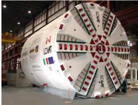
Εικόνα 3.9.7 Ένα από τα TBM-EPB της εταιρείας Lovat Inc που χρησιμοποιήθηκαν στο Μετρό του Τορίνο
