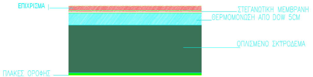
Εικόνα 5.3: Διάταξη δομικών στοιχείων οροφής.
