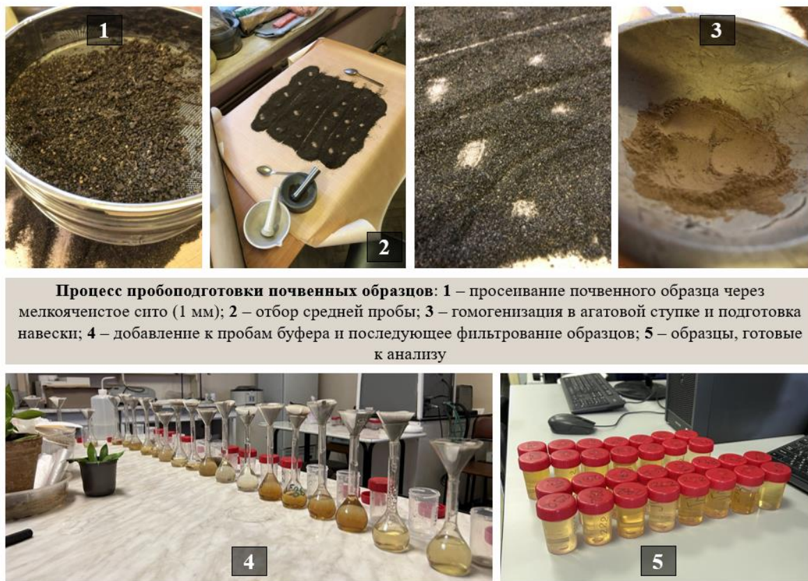
Рисунок 9 – Основные этапы пробоподготовки почв
