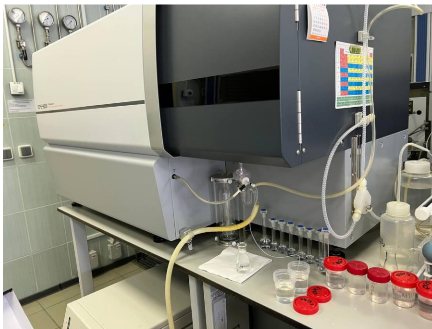
Рисунок 12 – Процесс анализа образцов на ICPE–9000
