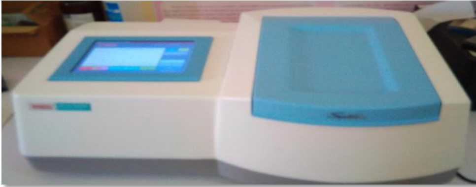
Figure (III. 3) : photo d'appareil UV-Visible
