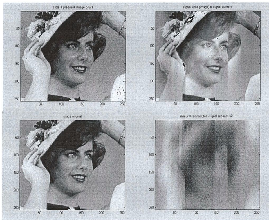
Figure 3.3 : Elimination d'une interférence pour une image bruitée (Signal bidimensionnel).
