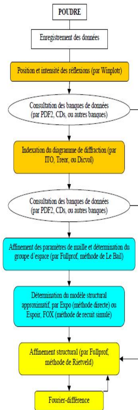
Figure 1a : Algorithme de la résolution structurale ab initio pour une poudre
