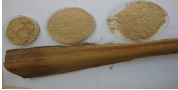
Figure IV-13: Aspects de la tige de dattes et des tailles de grains obtenus par broyage et tamisage.
