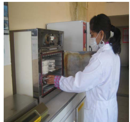
Foto 23. Desinfección de cajas petri, papel toalla y pinzas, en la estufa a una temperatura de 100 °C durante 24 horas
