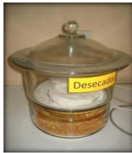
Foto 20. Colocacion de las muestras de semillas en la cámara de desecación durante 30 minutos.
