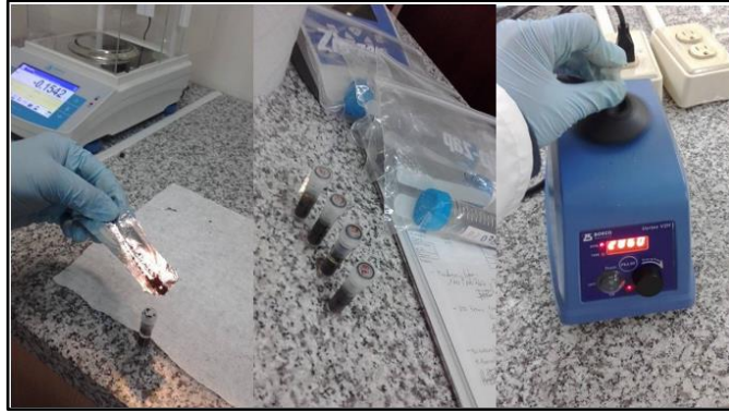
Imagen 14. Procedimiento de mezcla y vorteadado de las muestras de suelo con las soluciones para la extracción de ADN Fuente: El Autor
