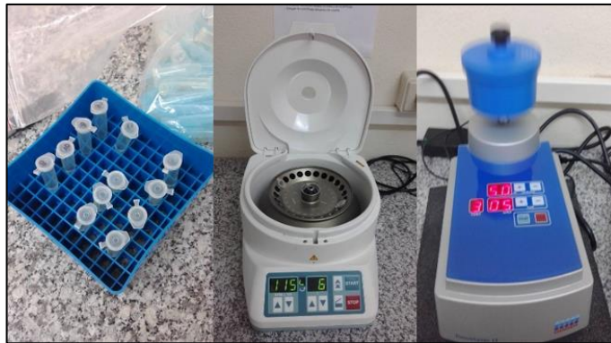
Imagen 15. Materiales utilizados en la extracción de ADN, junto a la centrífuga utilizada en el procedimiento Fuente: El Autor
