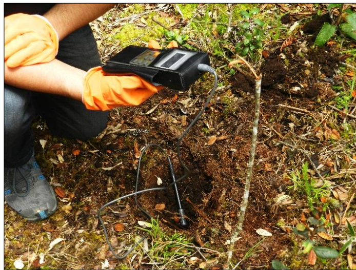
Imagen 13. Determinación de la humedad de suelo del BVPA a través del higrómetro, variable importante a considerar dentro de la preservación ex situ de las muestras recolectadas.
