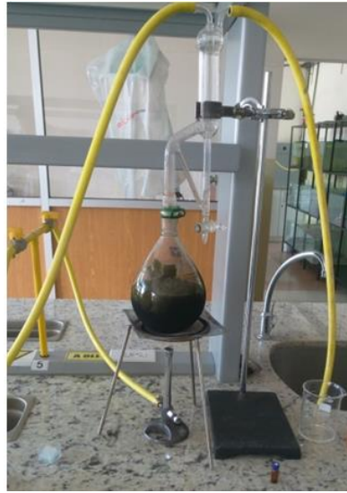
Figura 2. Equipo de hidrodestilación tipo cleveger. Elaborado por: La autora, 2018.
