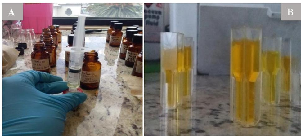
**Figura 11.** A.- Preparación de soluciones para lectura en frascos ámbar. B.- Reacción colorimétrica del cloruro de aluminio en los extractos.
