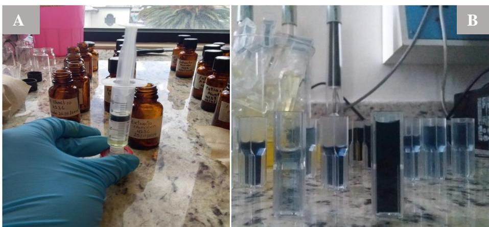
**Figura 10.** A.- Preparación de soluciones para lectura en frascos ámbar. B.- Reacción colorimétrica del reactivo de Folin ciocalteu con el Carbonato de sodio ( $\text{Na}_2\text{CO}_3$ ), en los extractos.
