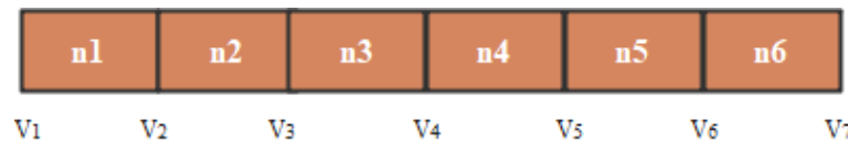
Figura 2.15. Electrodo segmentado en 6 partes
