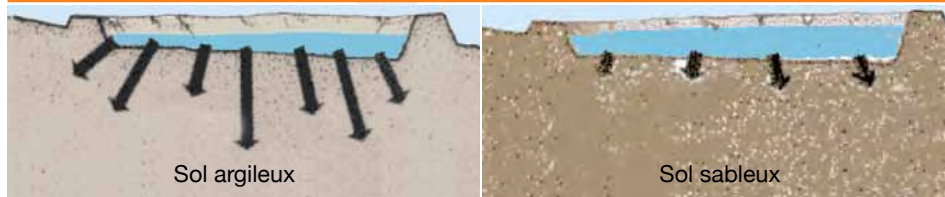
Figure 21. Imperméabilité des sols argileux et sableux.
