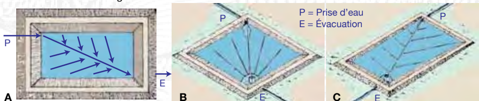
Figure 72. L'assiette. Direction de la pente (A) et disposition des drains : Rayonnant (B) ; En « arêtes de poisson » (C).
