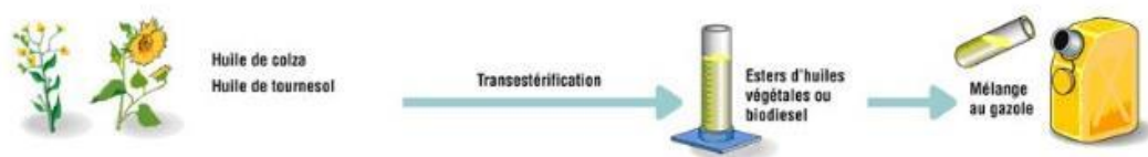
Figure n°94 : Les Esters méthyliques d'Huile Végétale (EMHV) ou biodiesel d'après le ministère de la transition écologique et solidaire (212)
