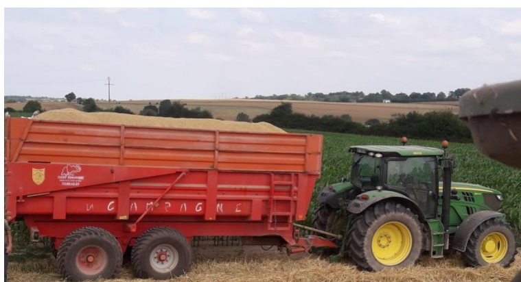
Figure n°164 : Photo d'une benne d'une capacité de 15 tonnes (photo LS)
