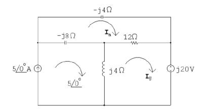
$$\begin{split} &(12-j12)\mathbf{I_a}-12\mathbf{I_g}-5(-j8)=0 \quad \text{(Loop I_a)} \\ &-12\mathbf{I_a}+(12+j4)\mathbf{I_g}+j20-5(j4)=0 \quad \text{(Loop I_g)} \end{split}$$
