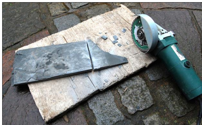
Na příříznutí stačí i obyčejná hobby bruska.
