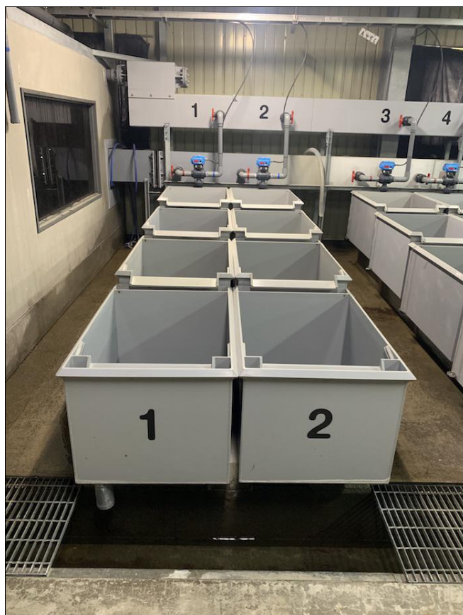
Průtočné kádě automatizovaného systému značení lososů v líhni.
