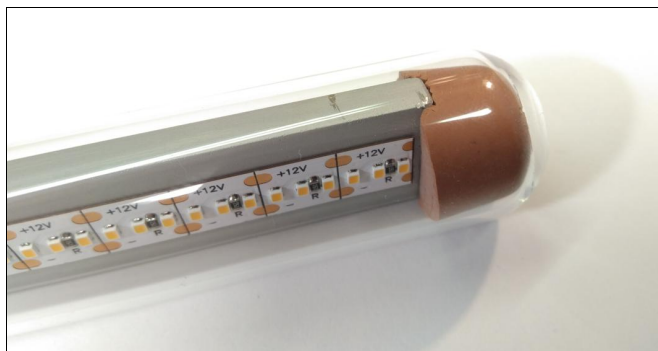
Obrázek 3: Zakončení a uložení hliníkového a LED pásku ve zkumavce.
