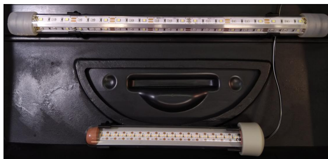
Obrázek 5: Kryt akvária s instalovaným vyrobeným (dole) a zakoupeným (nahore) LED svítidlem.
