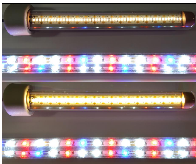
Obrázek 6: Porovnání světelných výkonů zhotoveného svítidla při napájení 4,5 V (nahore) a 6 V (dole) vůči zakoupenému svítidlu s barevnými LED.
