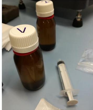
Figura 5. 2. Muestras del fluido reo-epesante compuesta de etilenglicol con 20% w/w de fumed silica.
