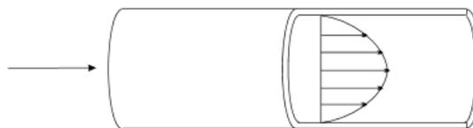
Figura 3. 5. Flujo en el interior de un tubo [27]
