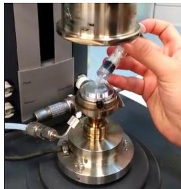
Figura 5. 6. Colocación de la muestra en la parte central de la placa móvil del reómetro.
