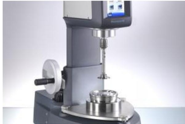
Figura 3. 2. Reómetro de placas paralelas [24]
