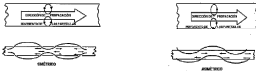
Figura 6 Mecánica de una onda de Lamb
