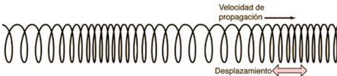
Figura 4 Mecánica de una onda longitudinal
