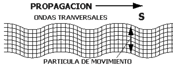
Figura 5 Mecánica de una onda transversal
