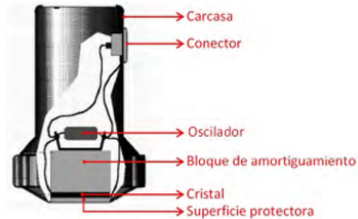
Figura 13 Partes de una sonda ultrasónica
