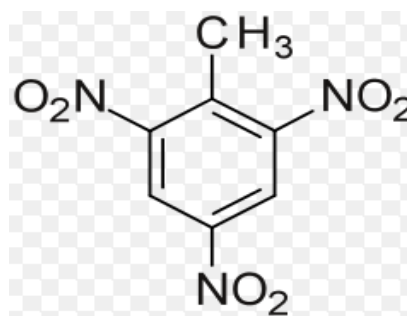
Figura 5b: Estructura del TNT ( \text{C}_7\text{H}_5\text{N}_3\text{O}_6 )
