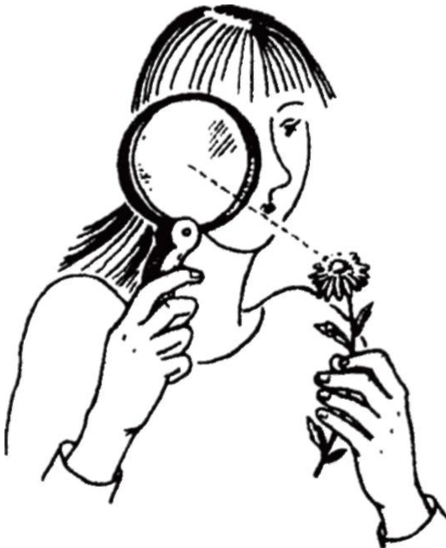
Рис. 6. Правило пользования лупой: объект анализа расположен в фокусе
