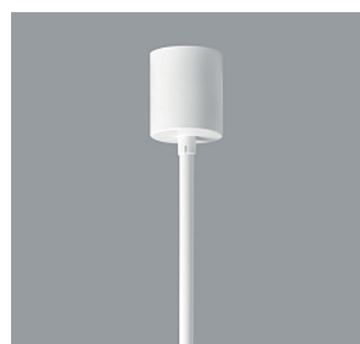
12446.000 Pendelrohrabhängung Pendelrohr: Metall, pulverbeschichtet. ø 13mm, L 1040mm. Baldachin: Kunststoff. ø 64mm, H 73mm. Belastung 20kg. Weiß CE Nur in Verbindung mit 78671.000 79551.000 79556.000 79561.000 79566.000 79571.000
