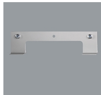
79501.000 Abhängebrücke für gerade Schienenverbindungen. Metall, verzinkt. Die Abhängebrücke kann nachträglich von oben in die ERCO Stromschiene eingesetzt werden. Belastung 20kg. L 180mm, H 47mm.
