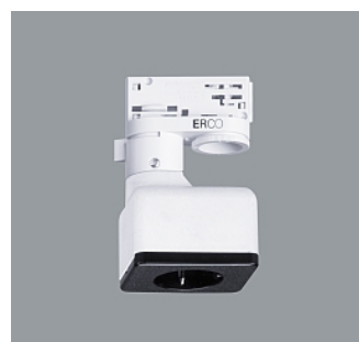
79023.000 ERCO 3-Phasen-Adapter Mit Schukosteckdose. 250V, 10A. Kunststoff. Abdeckung: Kunststoff, schwarz. L 71mm, B 56mm, H 90mm. Weiß CE
