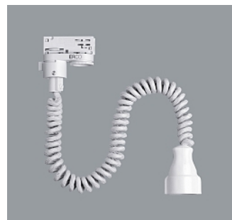
79053.000 ERCO 3-Phasen-Adapter Mit Schukokupplung. 250V, 6A. Wendelleitung 3x0,75mm 2 . L 700/1400mm. Weiß
