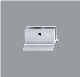
79504.000 Stoßstellenverbinder Mit zwei Schrauben. Aluminium, eloxiert. Belastung 30kg. L 50mm, H 26mm.
