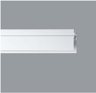
78350.000 Einputzprofil Aluminiumprofil, silber eloxiert. Zur deckenbündigen Montage von Strom- schiene in Putzdecken. B 40mm, H 52mm, L 3000mm. Gewicht 3,00kg
