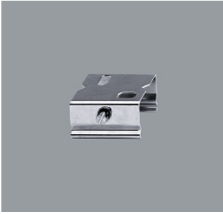
79503.000 Befestigungsklammer Federstahl, verzinkt. Belastung 20kg. L 33mm. Deckenabstand 14mm.
