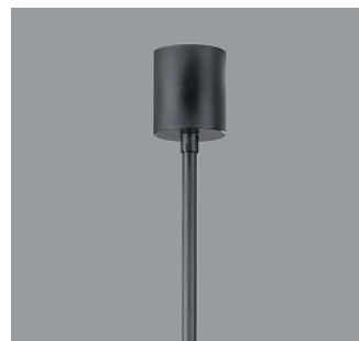
12445.000 Pendelrohrabhängung Pendelrohr: Metall, pulverbeschichtet. ø 13mm, L 1040mm. Baldachin: Kunststoff. ø 64mm, H 73mm. Belastung 20kg. Schwarz
