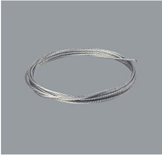
12440.000 Drahtseil Belastung 20kg. ø 1,75mm, L 10m.
