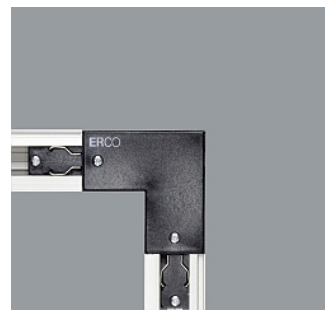
79327.000 3-Phasen-Eckverbinder Kunststoff. Schutzleiter außen. Einspeisung möglich. Durchverdrahtung. Schwarz ☞☞☞ ☞☞ ☞
