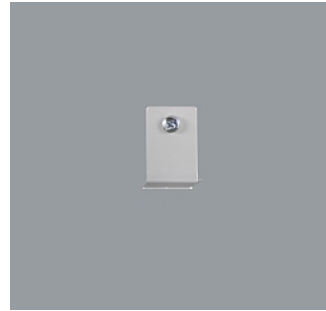
79500.000 Abhängung für Stromschiene Metall, verzinkt. Die Abhängung kann nachträglich von oben in die ERCO Stromschiene eingesetzt werden. Belastung 15kg. L 30mm, H 47mm.
