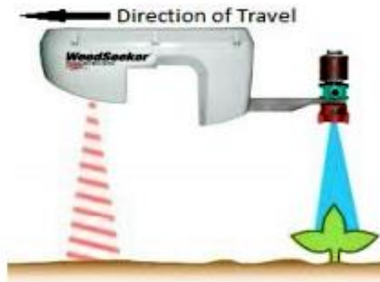
37. ábra: Gyomfelismerés és permetezés
