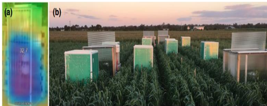
13. ábra: Fagykamrák (a) teljesítményvizsgálat és a búza fagyásának szimulációja (b)
