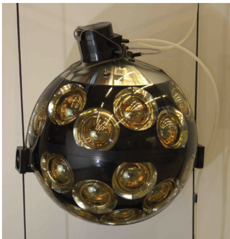
Abbildung 1.2: Ein Digital Optical Modul, welches bei KM3NeT zum Einsatz kommt [2]
