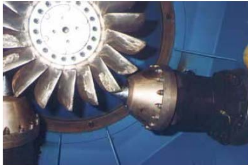
Εικόνα 5. Τύπου Pelton με 2 ακροφύσια
